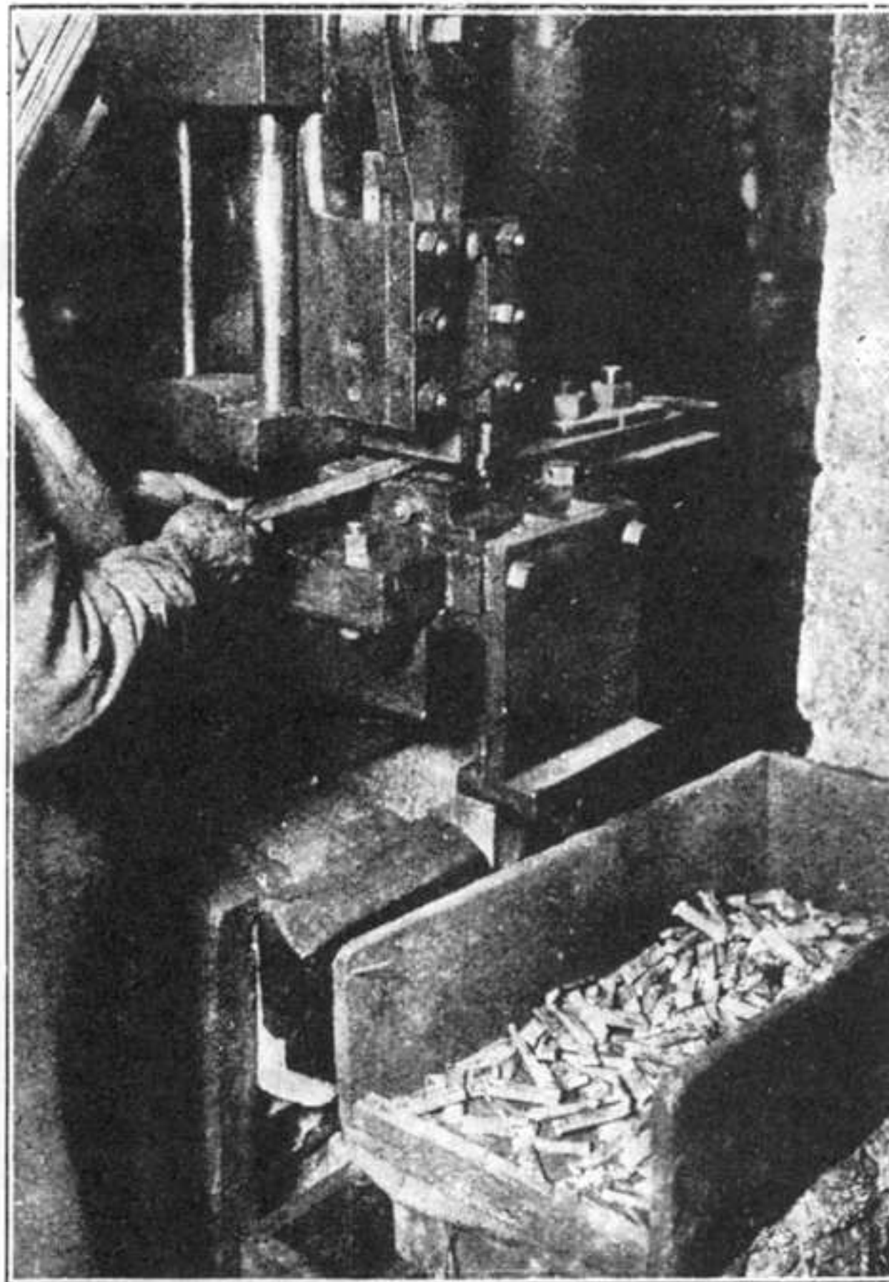
Première Opération : Découpage des morceaux d'acier ou de nickel.
