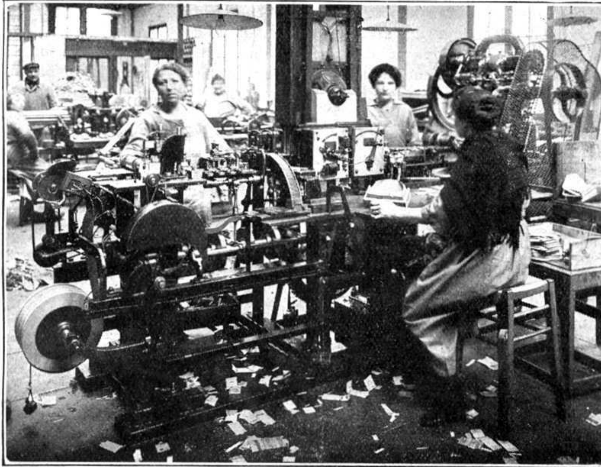
Machine Chasseigne à fabriquer les Allumettes Jupiter (arrivée des Pochettes garnies)
