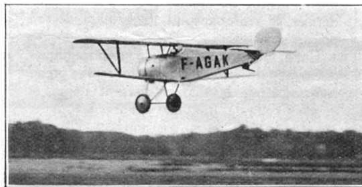
Farman "Chasse" monoplane Long. 7 m.; Envergure 9 m 50; Plafond 4.800 m. Vitesse 220 k. h.
