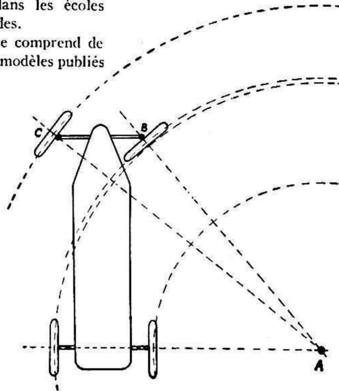
Fig. 3. — Diagramme montrant l'Auto attaquant un virage.
