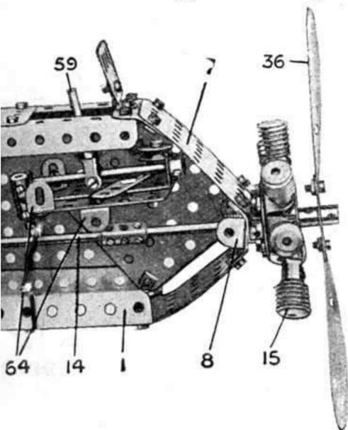
**Fig. 3. — Levier de Commande et Palonnier de Direction**
