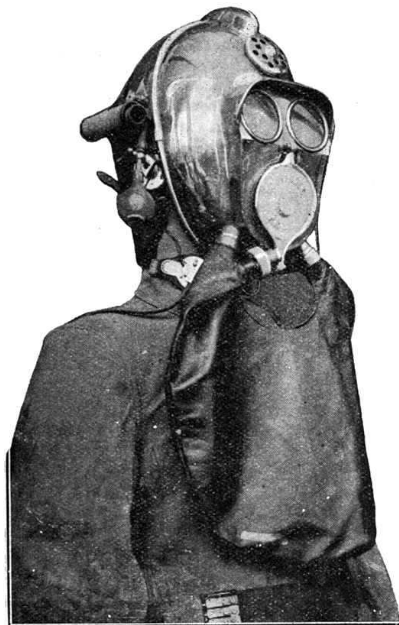
Un Masque terrifiant : le Laryngophone Cet appareil permet aux pompiers de téléphoner même munis du masque contre les gaz.
