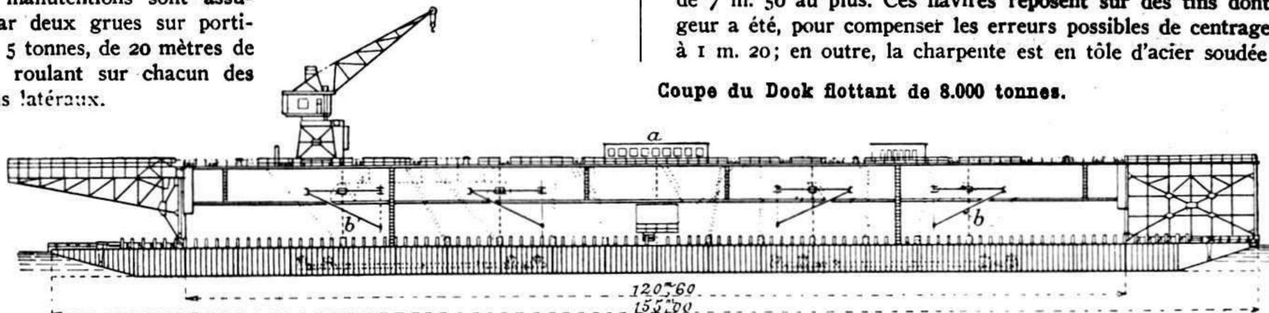
Quatre cabestans de 5 tonnes et quatre autres de 15 tonnes sont installés sur les ponts supérieurs, pour le halage du navire dans le dock et pour aider aux délicates opérations que constituent son centrage et sa mise à sec sur la ligne des tins.
