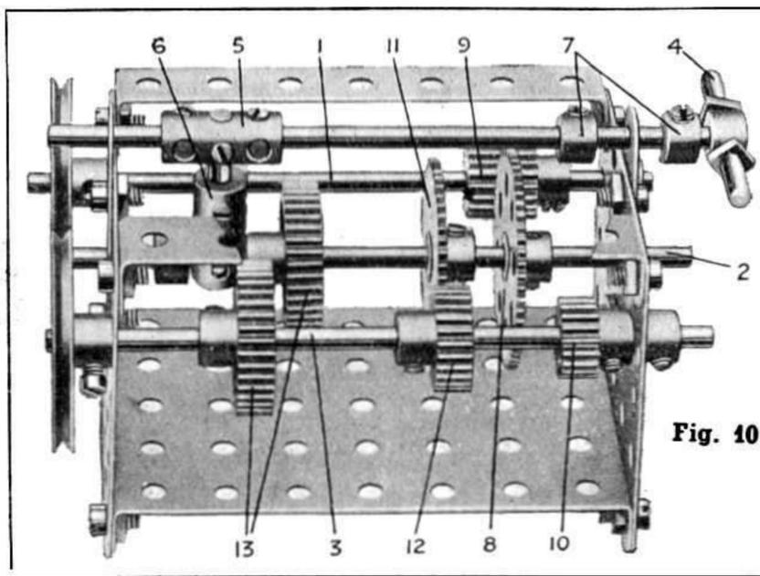
niques 5, en tournant sur l'essieu arrière, entraînent les Engrenages 6 et 7 à la même vitesse, mais dès que l'une des roues locomotrices ralentit sa rotation ou s'arrête complètement, comme il arrive aux tournants, l'un des Engrenages 6 ou 7 ralentit également, et les numéros 5 tendent à tourner autour de sa denture, ce qui augmente la vitesse de l'Engrenage opposé.
