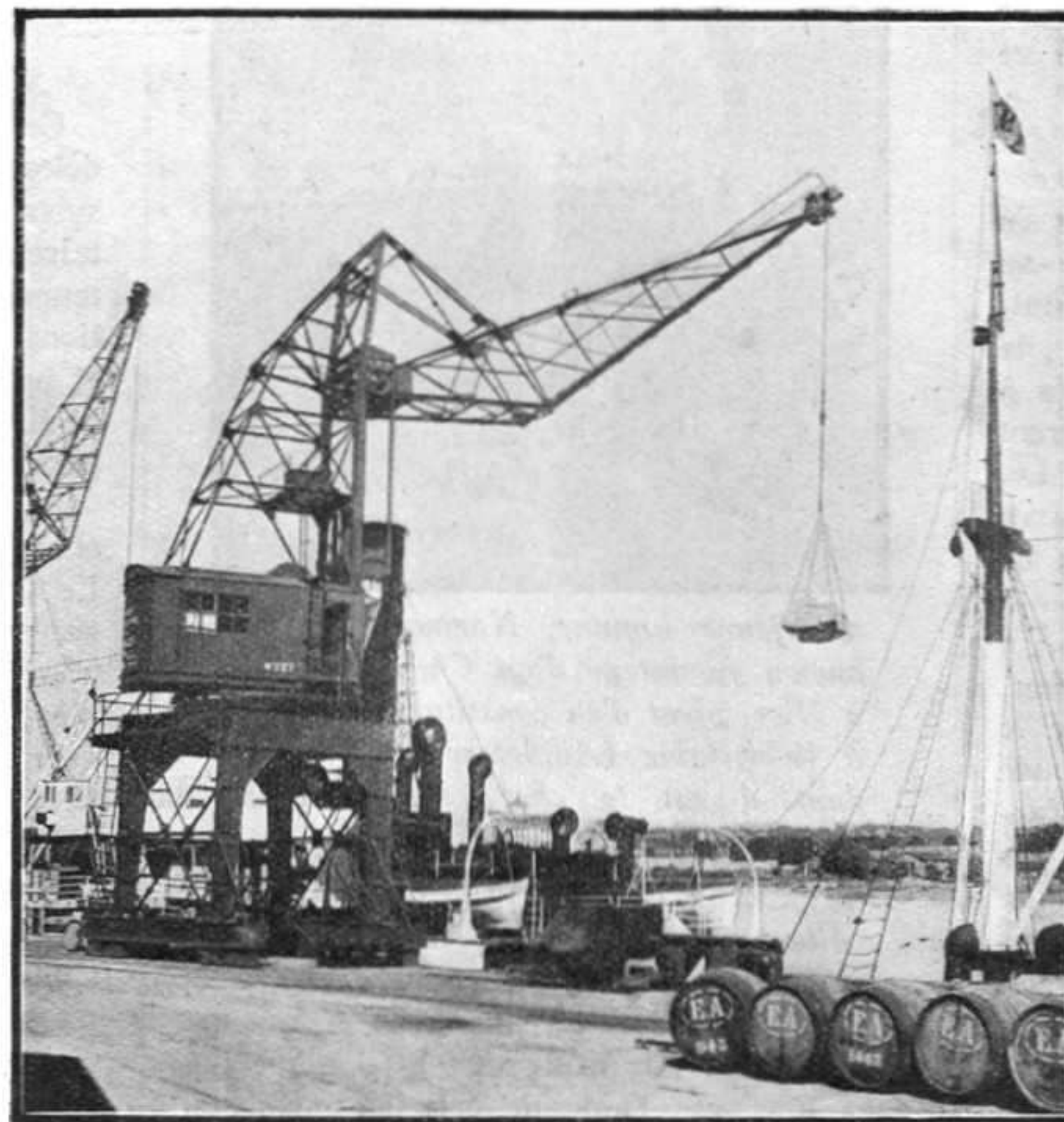
Grue électrique de 3 tonnes à portée variable
