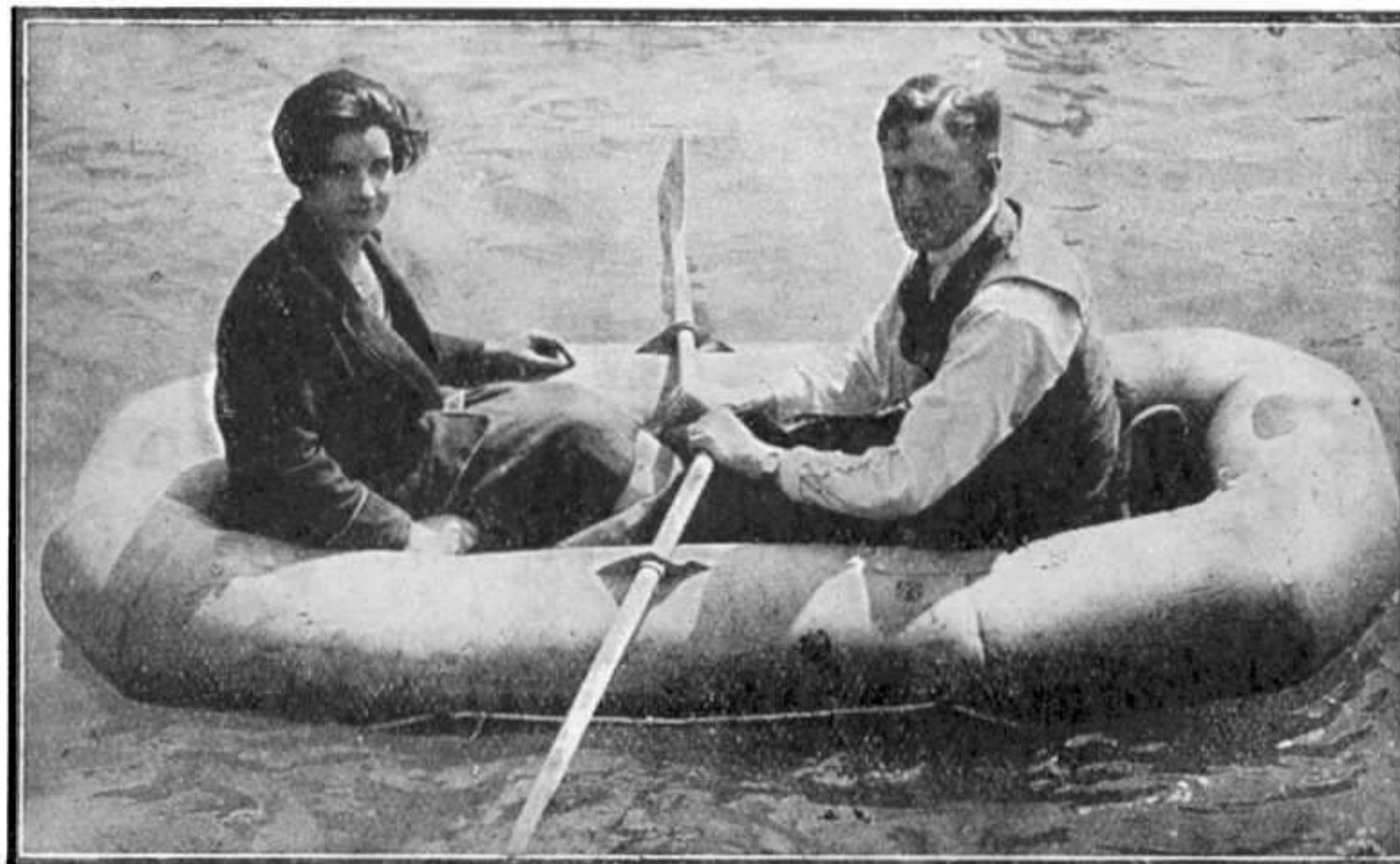
Cette petite embarcation pliante pouvant contenir deux personnes est une espèce de canot de sauvetage dont sont munis certains avions modernes.
