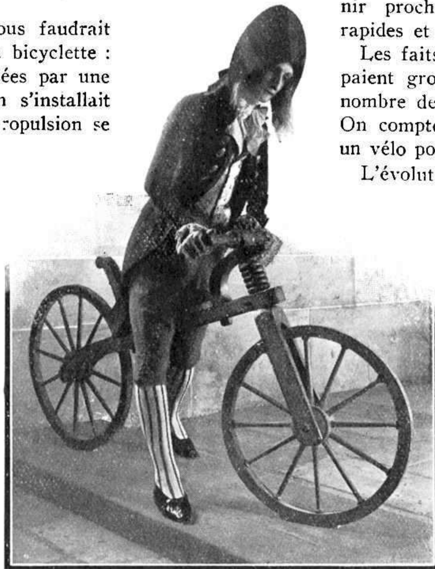
Un ancêtre de la bicyclette : draisienne à amortisseur. (Musée de la Voiture à Compiègne).
