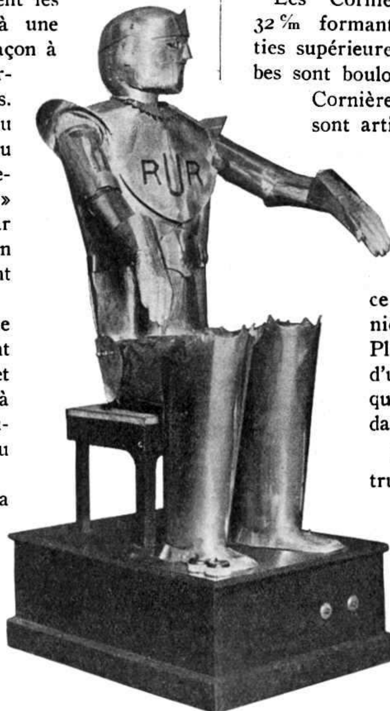
Fig. 4. — Ce « Robot » s'assoit, se lève et exécute les mouvements les plus variés en obéissant à la voix humaine.
