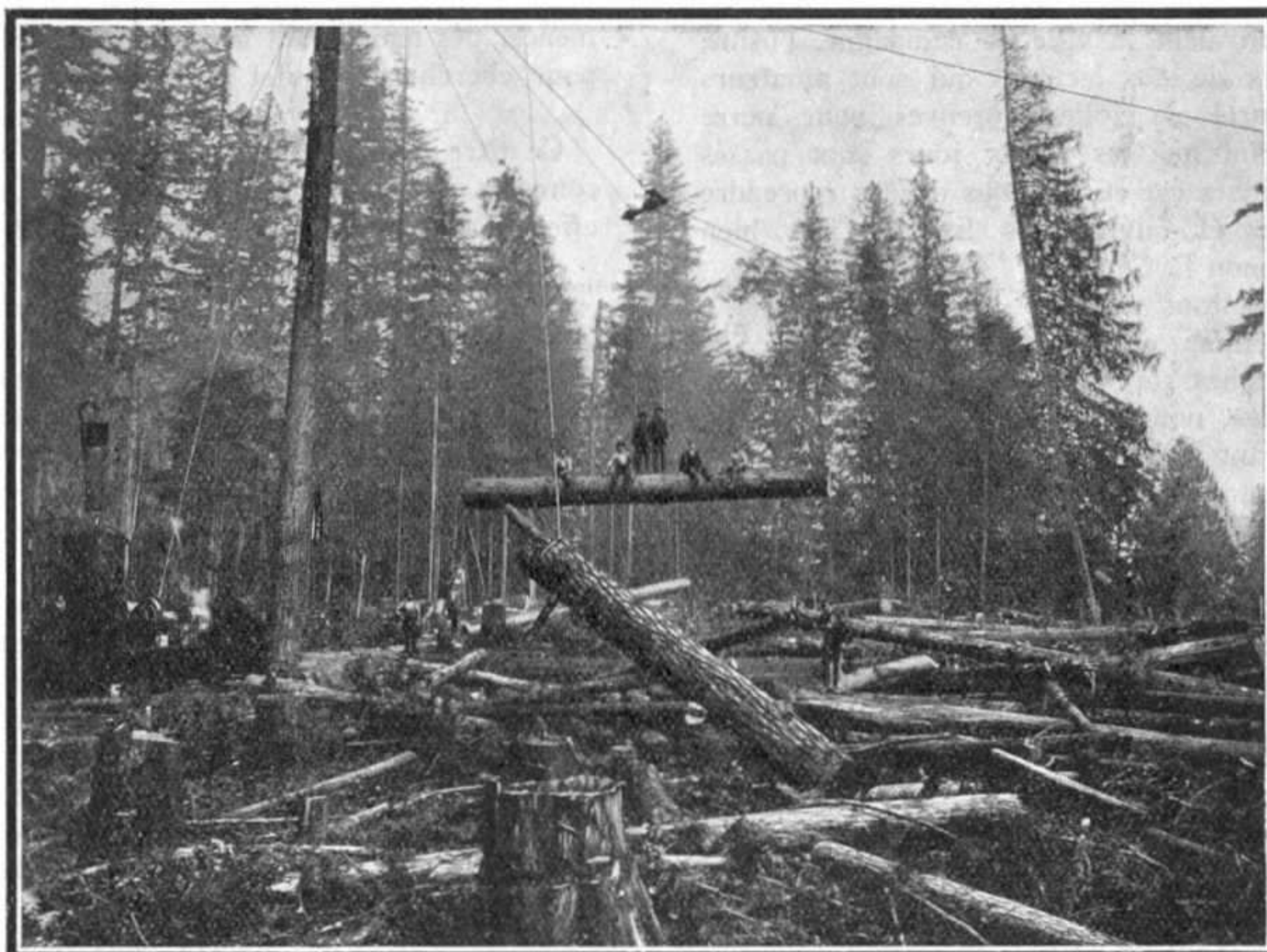
Une scène dans la forêt canadienne. Les troncs d'arbre sciés sont transportés au moyen d'un système téléphérique au chemin de fer traversant la forêt.
