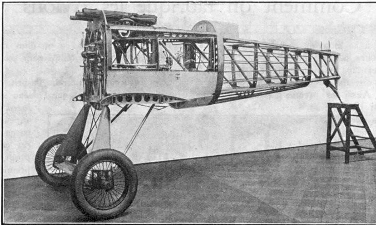
Fuselage d'un Avion Blériot Spad 91 léger.
