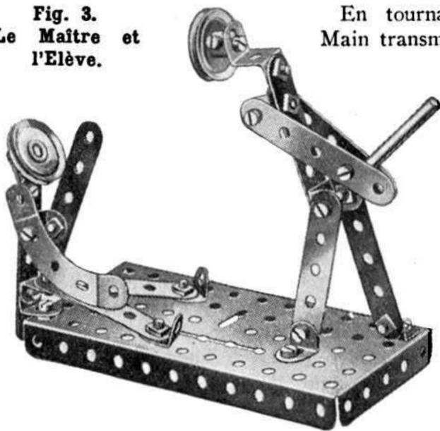
En tournant, la Manivelle à Main transmet par l'intermédiaire de la Bande-bielle un mouvement de balancement à la partie supérieure du forgeron, et fait ainsi s'élever le marteau qui retombe ensuite avec force sur l'enclume.
