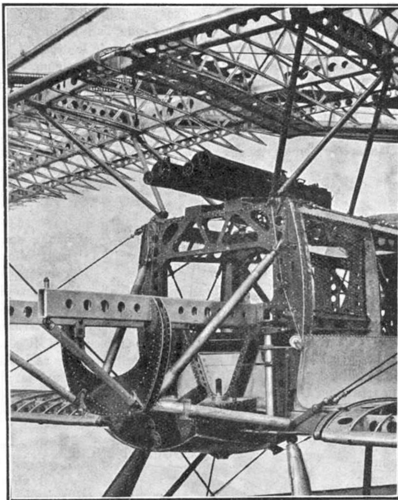
Une partie du Fuselage de l'Avion Spad 91 montrant la manière dont sont fixées les Ailes.
