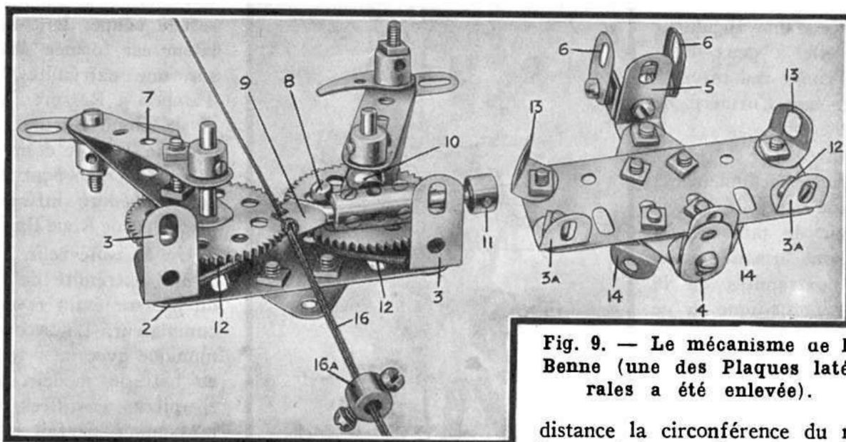
Fig. 9. — Le mécanisme de la Benne (une des Plaques latérales a été enlevée).
