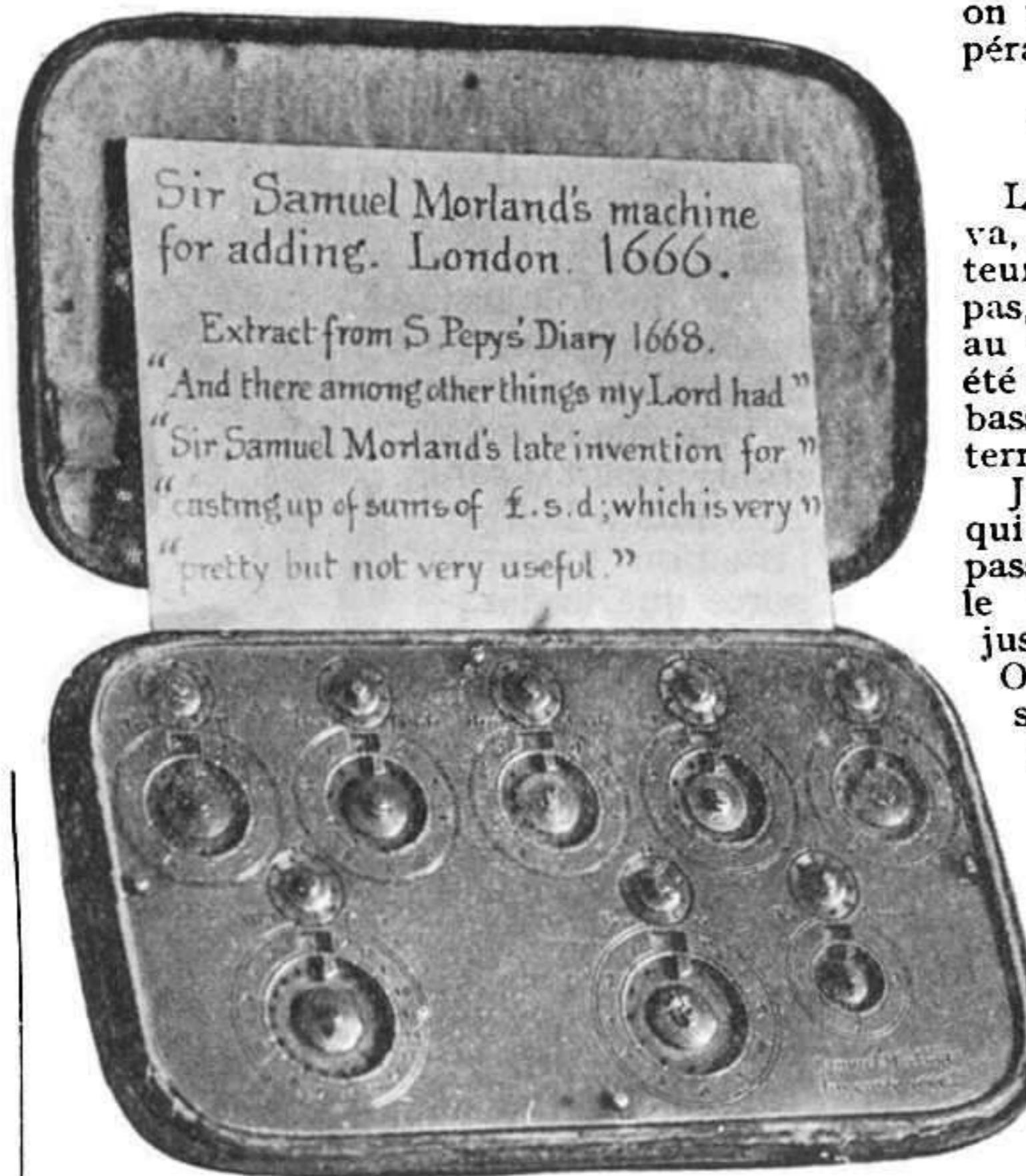
Notre photo ci-dessus représente la plus ancienne machine à additionner, qui fut construite en 1666, à Londres, par Sir Samuel Morland. Un rapport de l'époque, que l'on voit sur la photo, dit que « cet appareil est bien charmant, mais pas très utile ».
