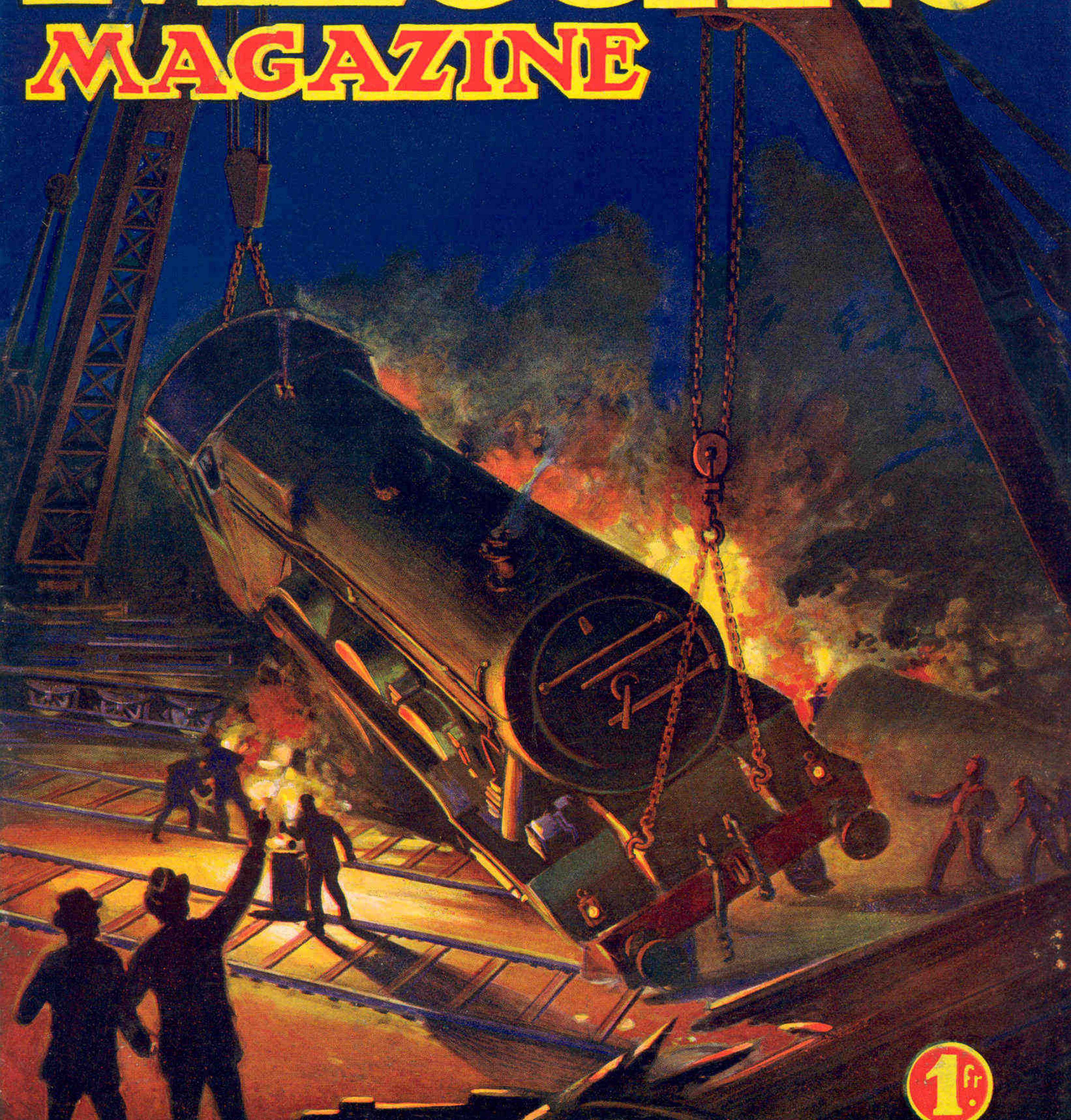
APRÈS UN ACCIDENT DE CHEMIN DE FER. GRUE DE DÉPANNAGE EN ACTION. (Voir page 243)
