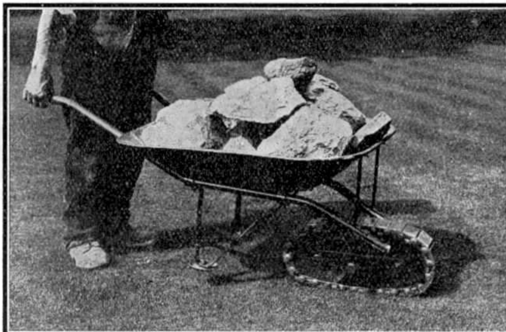
La chenille aînée du jardinier. Si les larves nuisibles qui portent ce nom sont les ennemies redoutées du cultivateur, il n'en est pas ainsi pour le dispositif mécanique appelé « chenille ». Comme le montre le cliché ci-dessus, l'emploi de cette ingénieuse invention ne se borne pas aux tracteurs, aux autos et aux chars d'assaut. Monté sur une brouette, il rend des services appréciables sur les terrains parsemés d'obstacles et détrempés.
