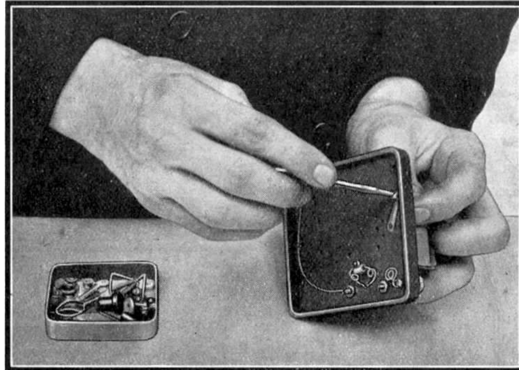
Montage des fils de connexion pour la construction de la Sonnette Electrique Elektron.
