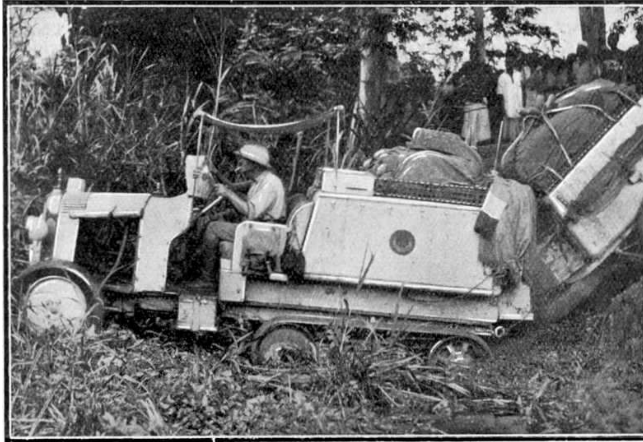
Autochenille Citroën-Kegresse franchissant un ravin au cours d'un raid d'exploration à travers l'Afrique. Les clichés illustrant cet article, nous ont été confiés aimablement par la Citroën-Kegresse Ltd, Londres.
