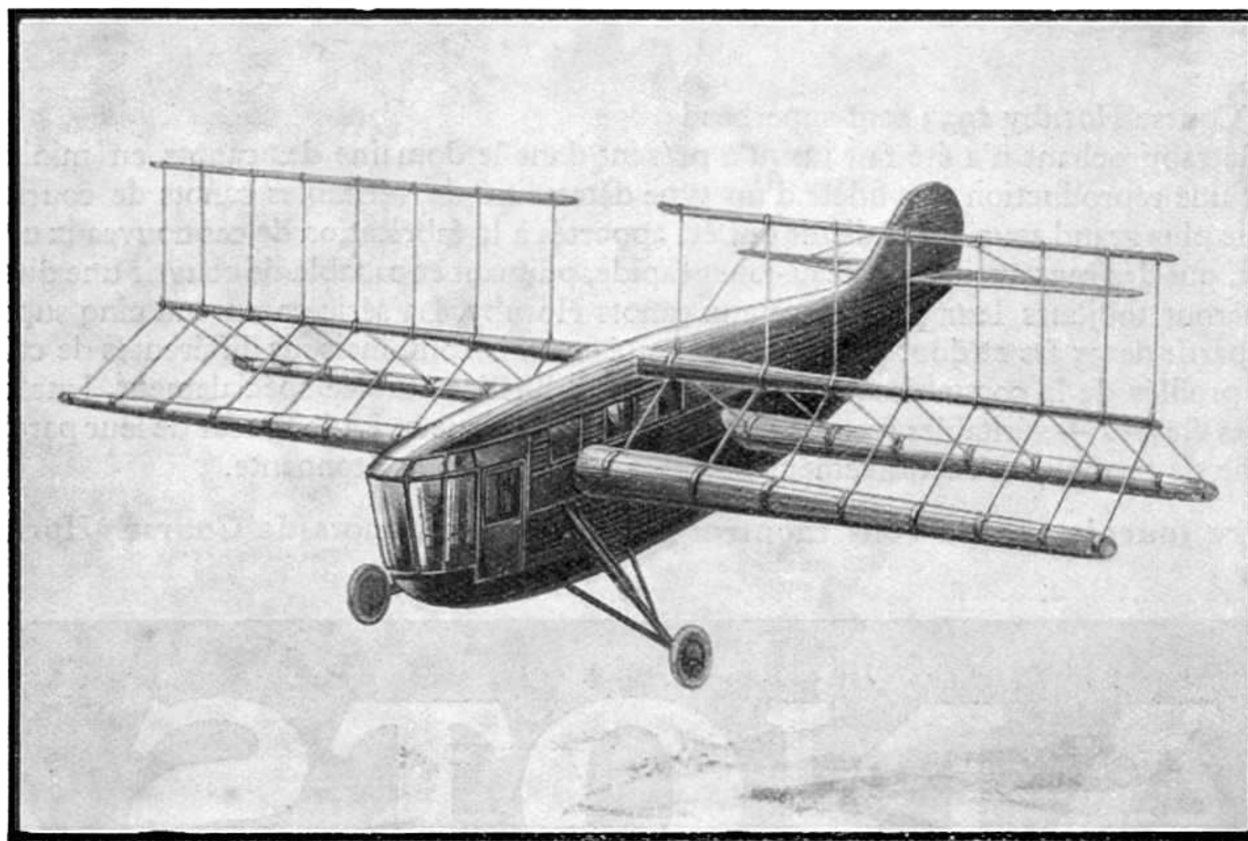
Photo de la revue aéronautique Les Ailes . Vue du nouvel avion à aile rotative Rohrbach dont il a été question dans le Meccano-Magazine d'avril. Les ailes rotatives, entraînées par un moteur disposé à l'intérieur de la carlingue, tournent autour d'un axe fixe qui sort des côtés du fuselage, à l'endroit où sont disposées les ailes fixes d'un avion ordinaire. L'avantage essentiel de l'appareil réside dans la possibilité de partir verticalement, comme un hélicoptère, de se maintenir en l'air sur place et même de reculer.
