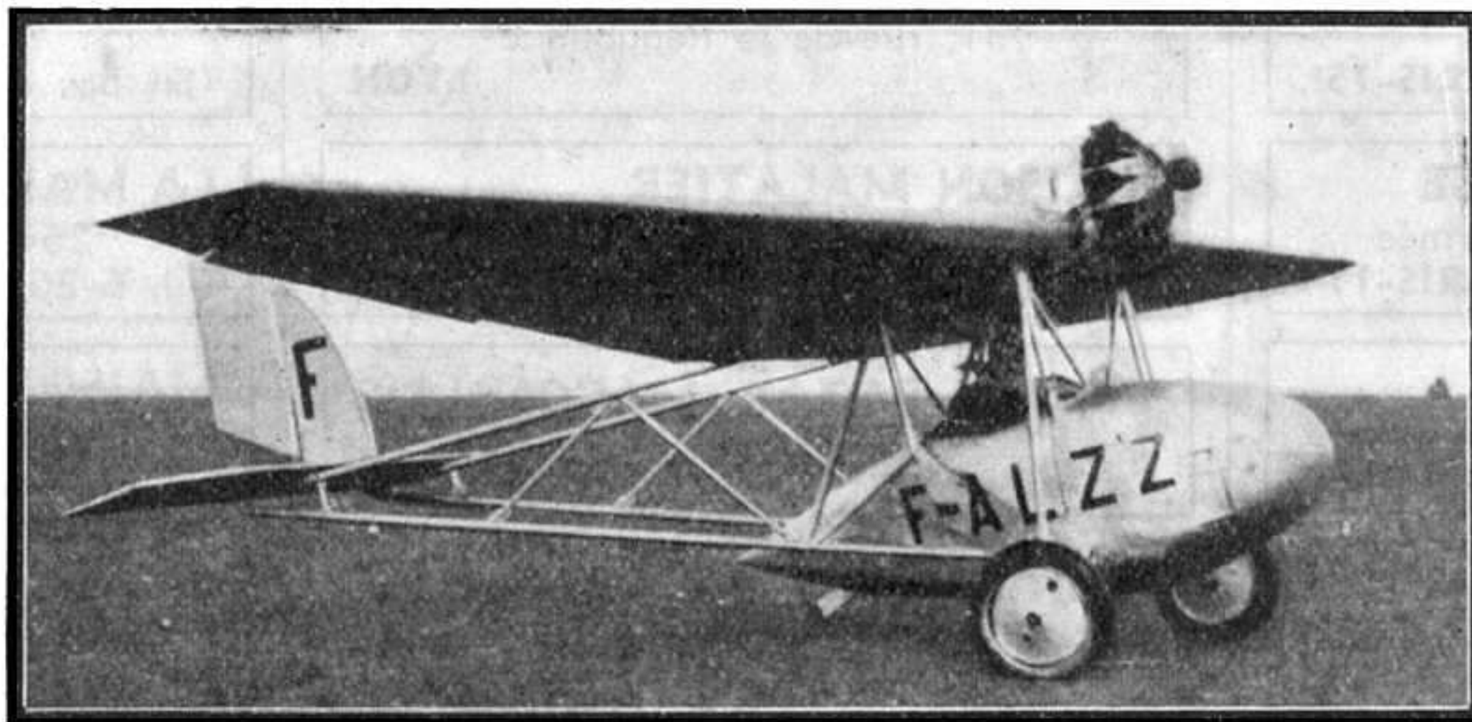
Vue de l'avion de promenade et d'école Basson type "Rubis", monoplan biplace, entièrement métallique, équipé avec un moteur Salmson de 40 CV. Ce cliché a été exécuté d'après une photographie qui nous a été confiée par la revue aéronautique "Les Ailes"
