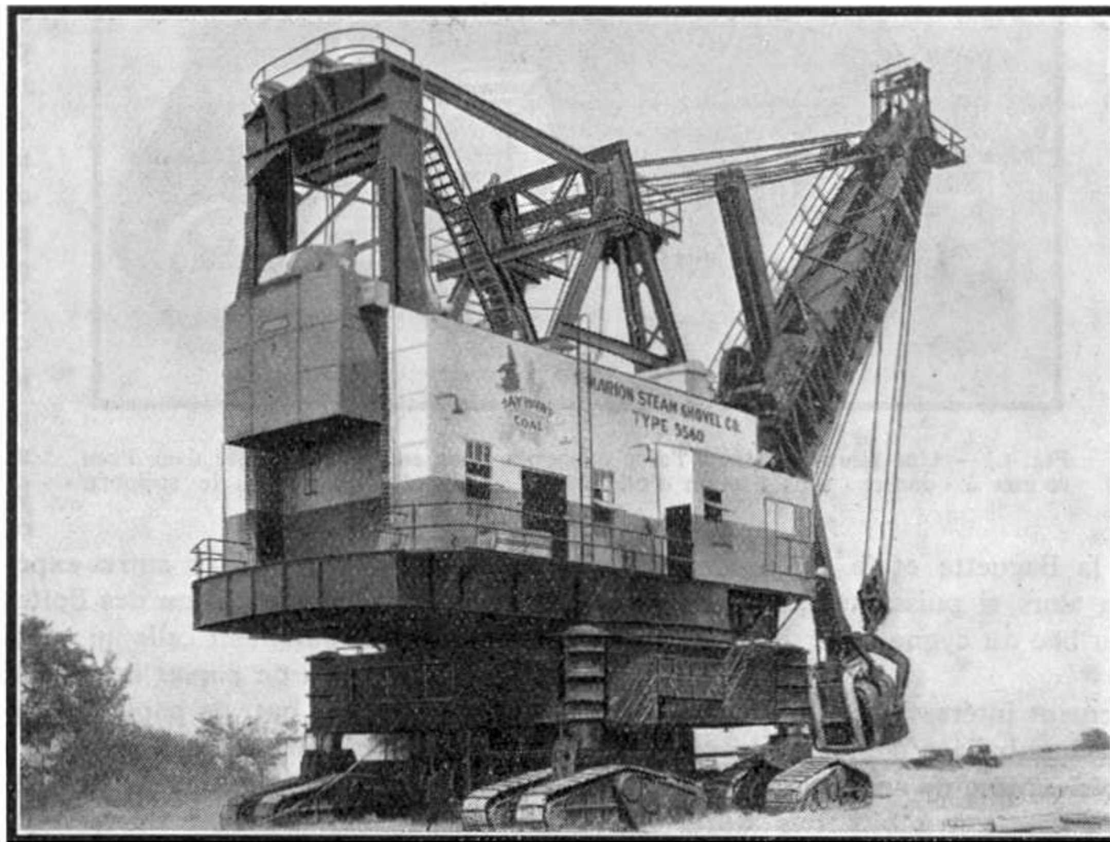
Excavateur électrique géant dont la pelle a une capacité de 14 mètres cubes. Photographie de la "General Electric Company" de New-York.
