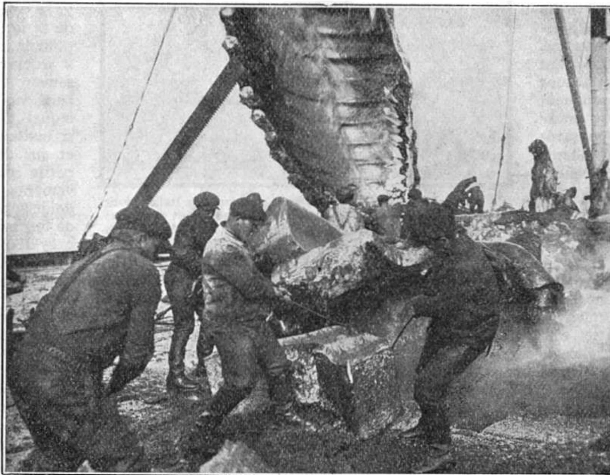
La baleine ayant été dépeçée, la carcasse géante de l'animal est découpée à l'aide de scies à vapeur spéciales. On voit ici l'équipage d'un baleinier à cette besogne. Les deux clichés de cette page nous ont été gracieusement prêtés par la Société Sir W. G. Armstrong Whitworth et C o Ltd., Londres S. W. I.
