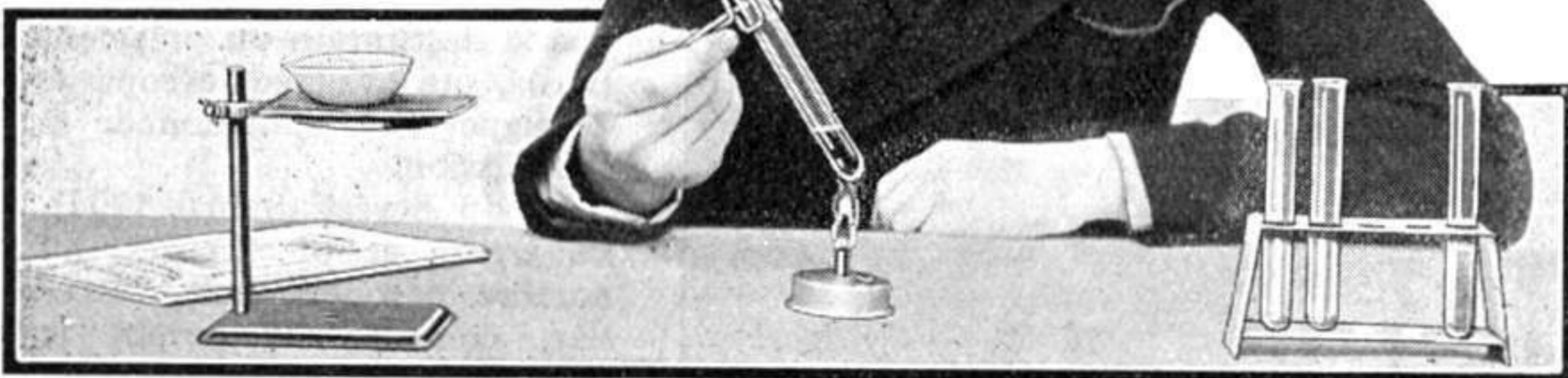
Fig. 1. Ce cliché donne une bonne idée de la façon dont doivent être disposés les différents appareils pendant que l'expérimentateur est en train de préparer une solution en chauffant un produit chimique dans une éprouvette contenant de l'eau.
