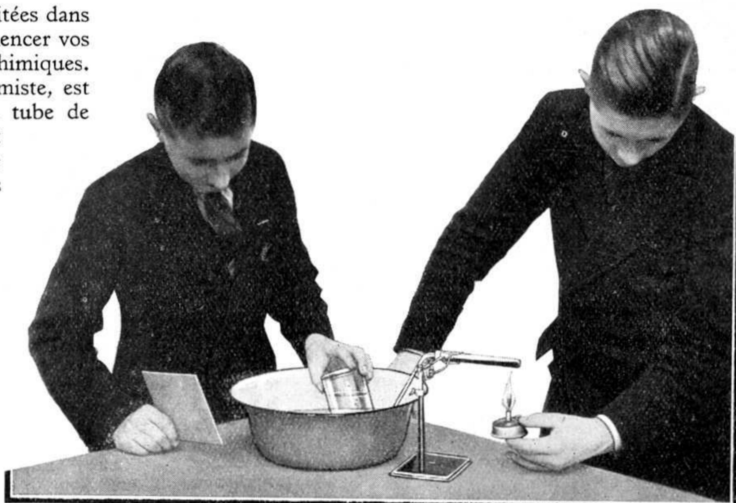
Fig. 4. — Préparation d'oxygène. Il est recommandé pour cette expérience de s'assurer l'aide d'un collaborateur pour lui faire tenir le bocal destiné à recueillir l'oxygène qui se dégage de l'éprouvette.
