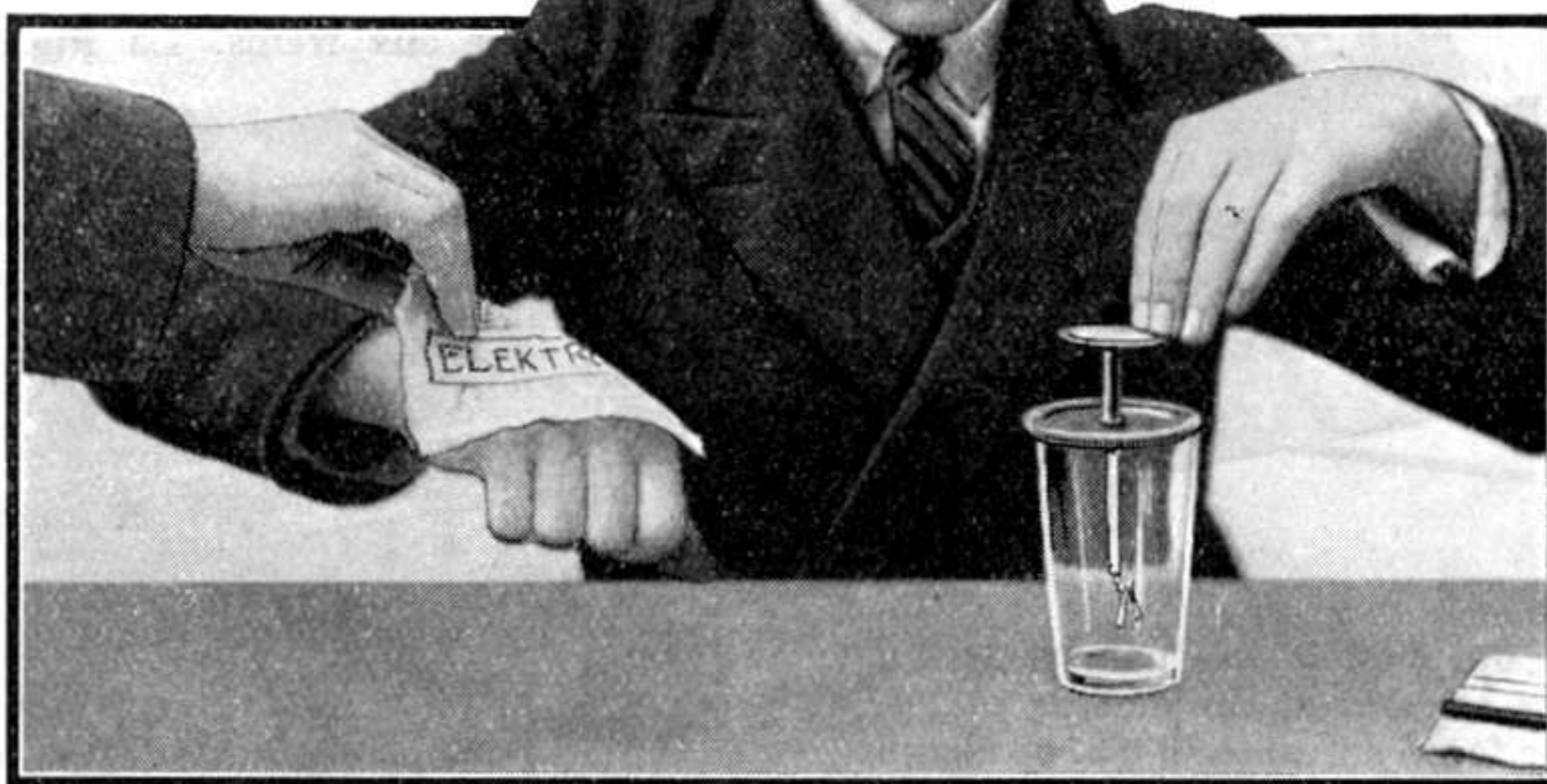
Fig. 2. — On électrise l'expérimentateur en lui frottant la main avec le carré de soie. Le phénomène de l'électrisation est révélé par l'écartement des feuilles de l'électroscope.
