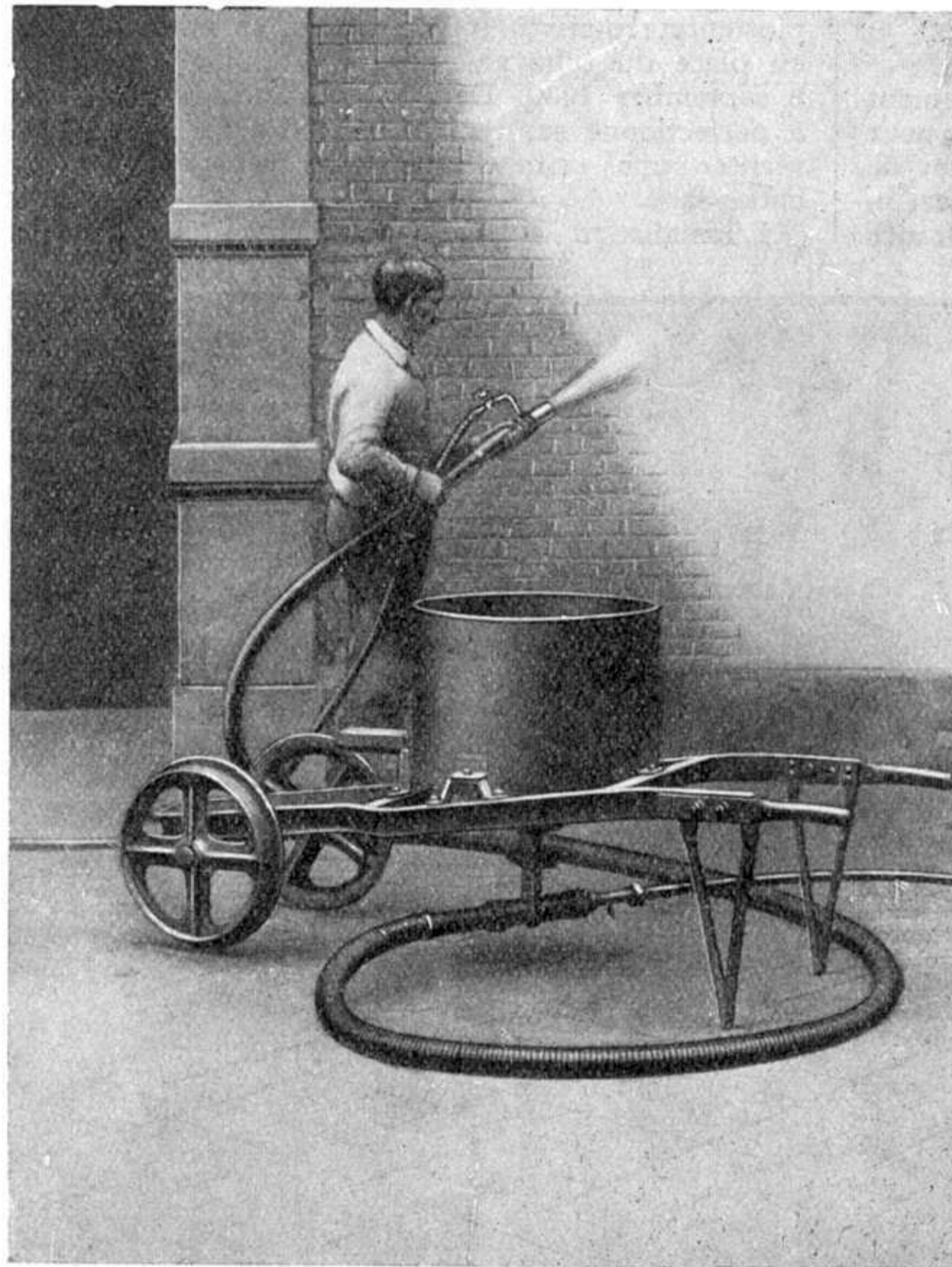
Machine à enduire, fonctionnant à l'air comprimé. Elle se compose d'une bache en tôle dans laquelle on jette à la pelle un mélange sec (sable, ciment) et d'un éjecteur-distributeur sur lequel arrive l'air comprimé par un tuyau de caoutchouc. L'éjecteur aspire le mélange et l'entraîne dans le jet d'air comprimé qui l'emporte à grande vitesse dans un autre tuyau aboutissant à la lance qui reçoit également l'eau sous pression. Cette eau s'incorpore au mélange et forme avec lui un mortier homogène, projeté vigoureusement par la lance.
