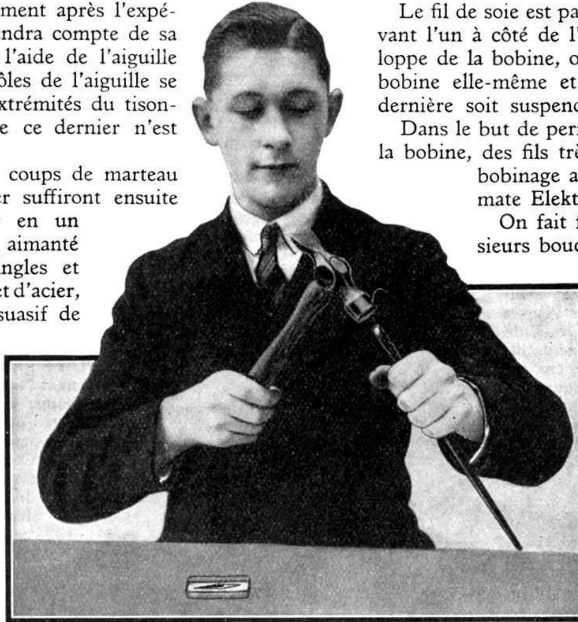
Fig. 2. Tisonnier aimanté à coups de marteau.
