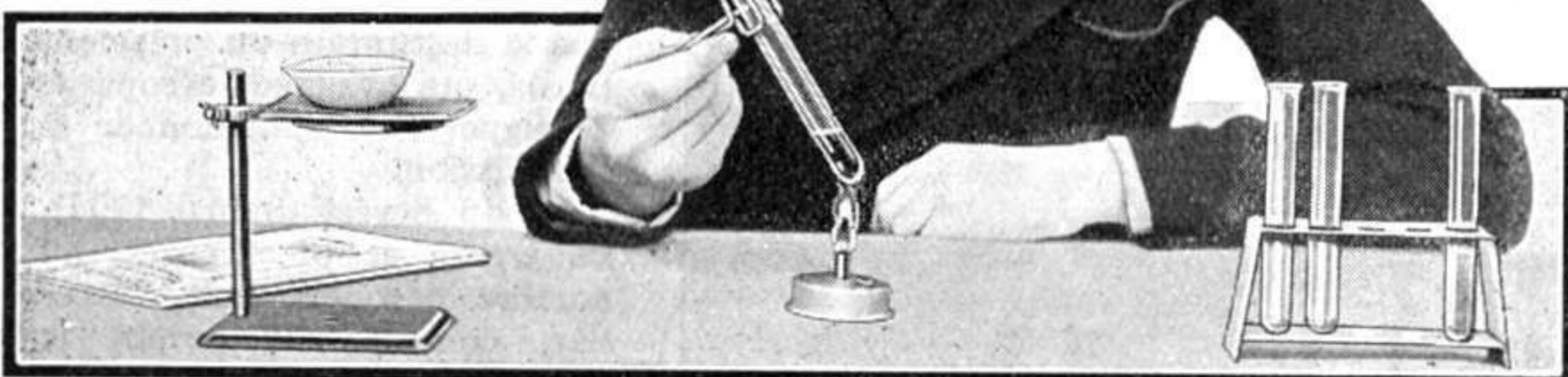
Fig. 1. Ce cliché donne une bonne idée de la façon dont doivent être disposés les différents appareils pendant que l'expérimentateur est en train de préparer une solution en chauffant un produit chimique dans une éprouvette contenant de l'eau.
