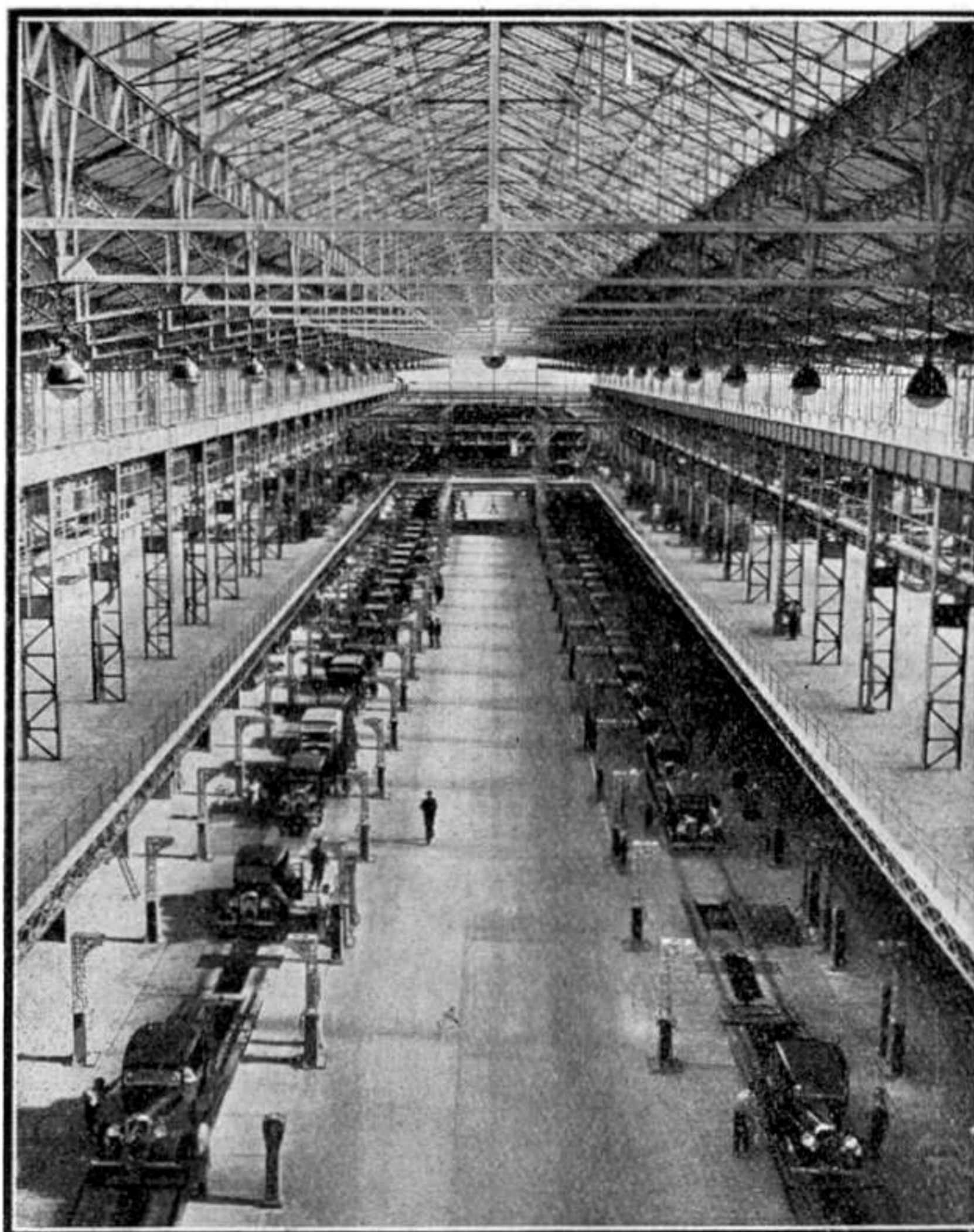
Une vue impressionnante du nouveau hall de montage final des voitures Citroën. Dans cette salle monumentale, où règnent l'ordre, le silence et la propreté, chaque ouvrier, au bord de la chaîne, est à sa place. Il accomplit posément sa besogne, sans hâte, soigneusement, mais aussi sans perdre de temps. En défilant devant lui, le cadre, auquel chaque main ajoute une pièce, devient châssis, puis le châssis devient voiture.
