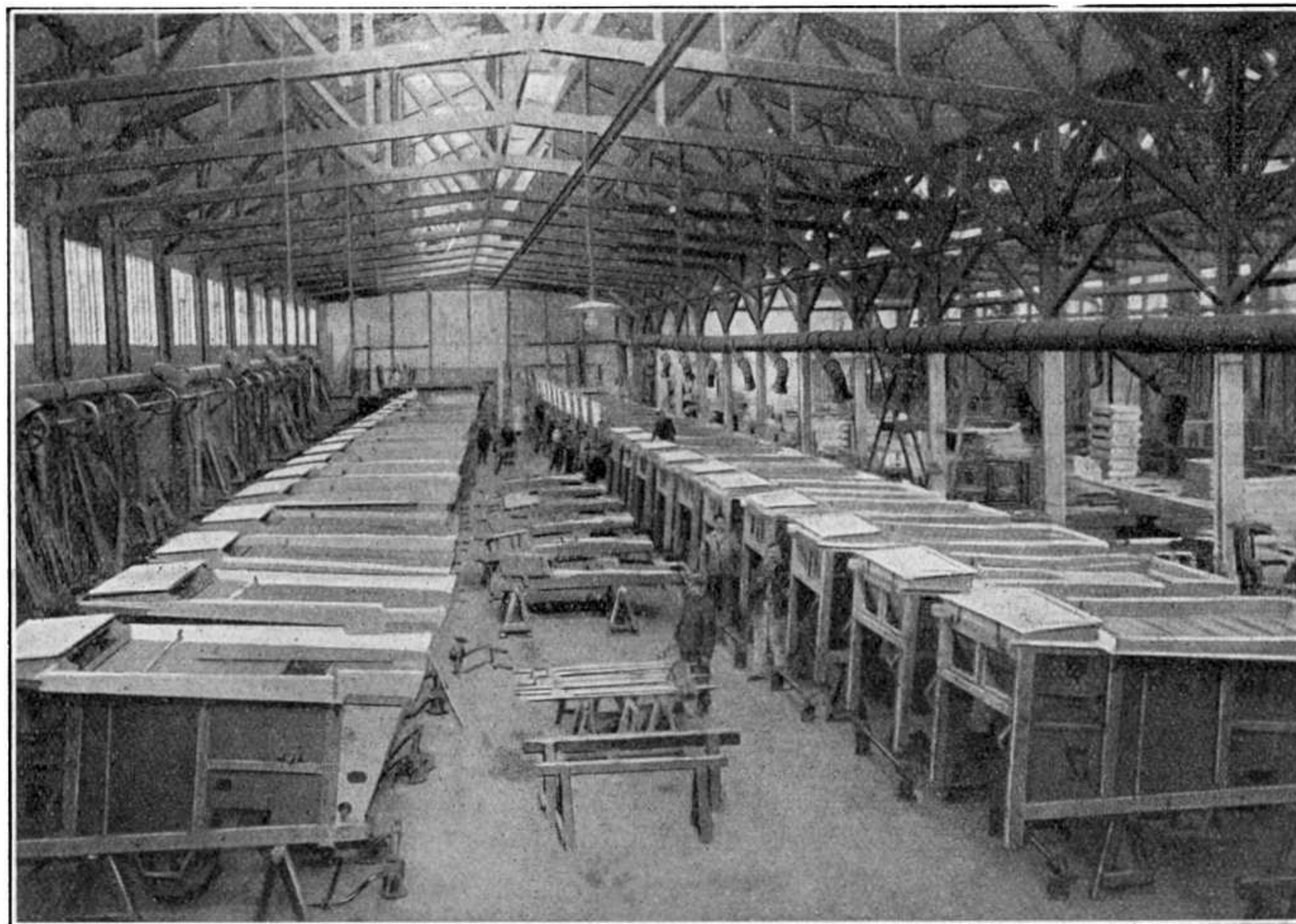
Construction de batteuses en série. Cliché des Anciens Etablissements Albaret.
