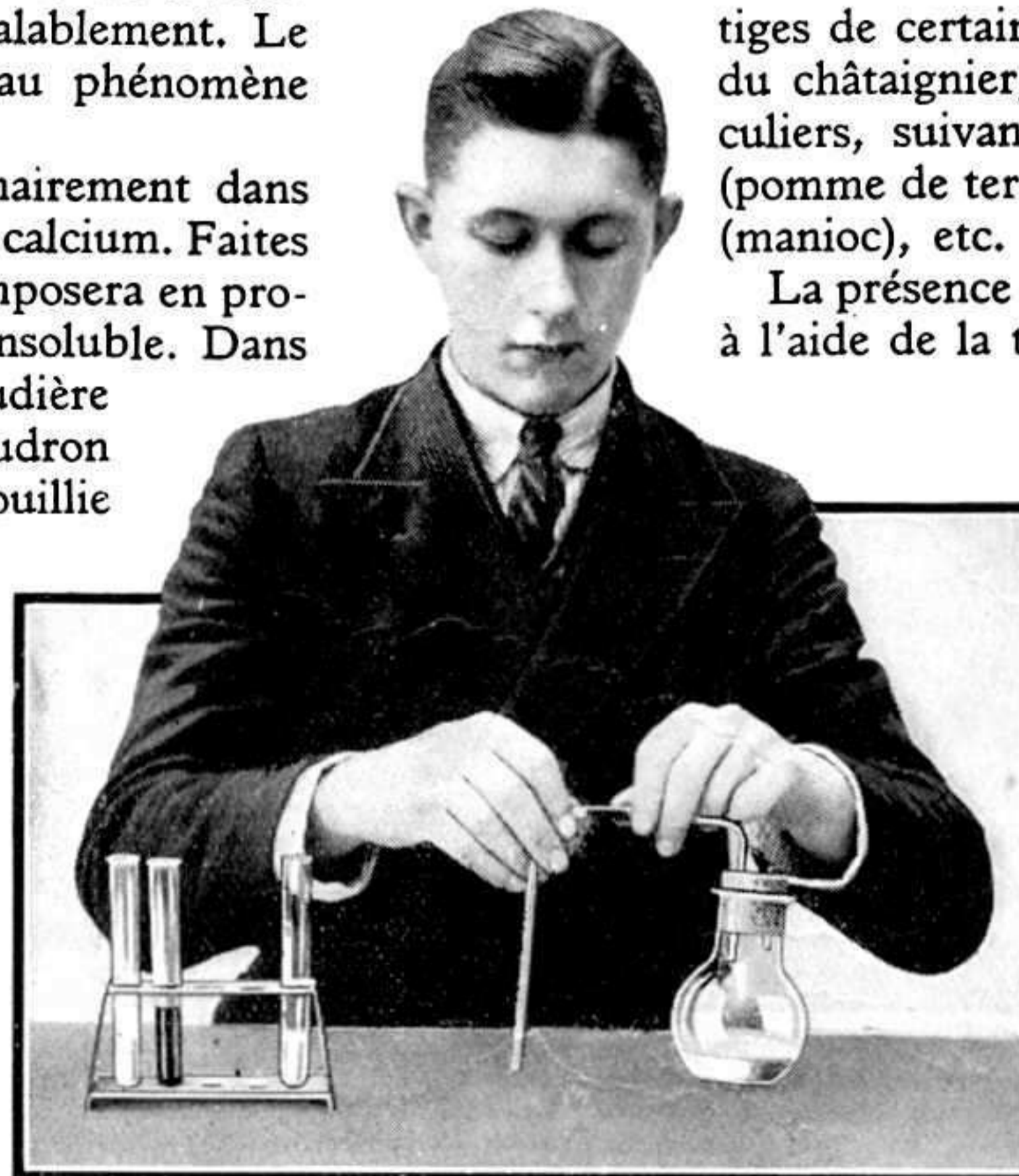
Pour étudier l'action de la levure sur une solution de sucre, faites dissoudre une cuillerée de sucre dans de l'eau contenue dans le ballon et ajoutez-y de la levure.
