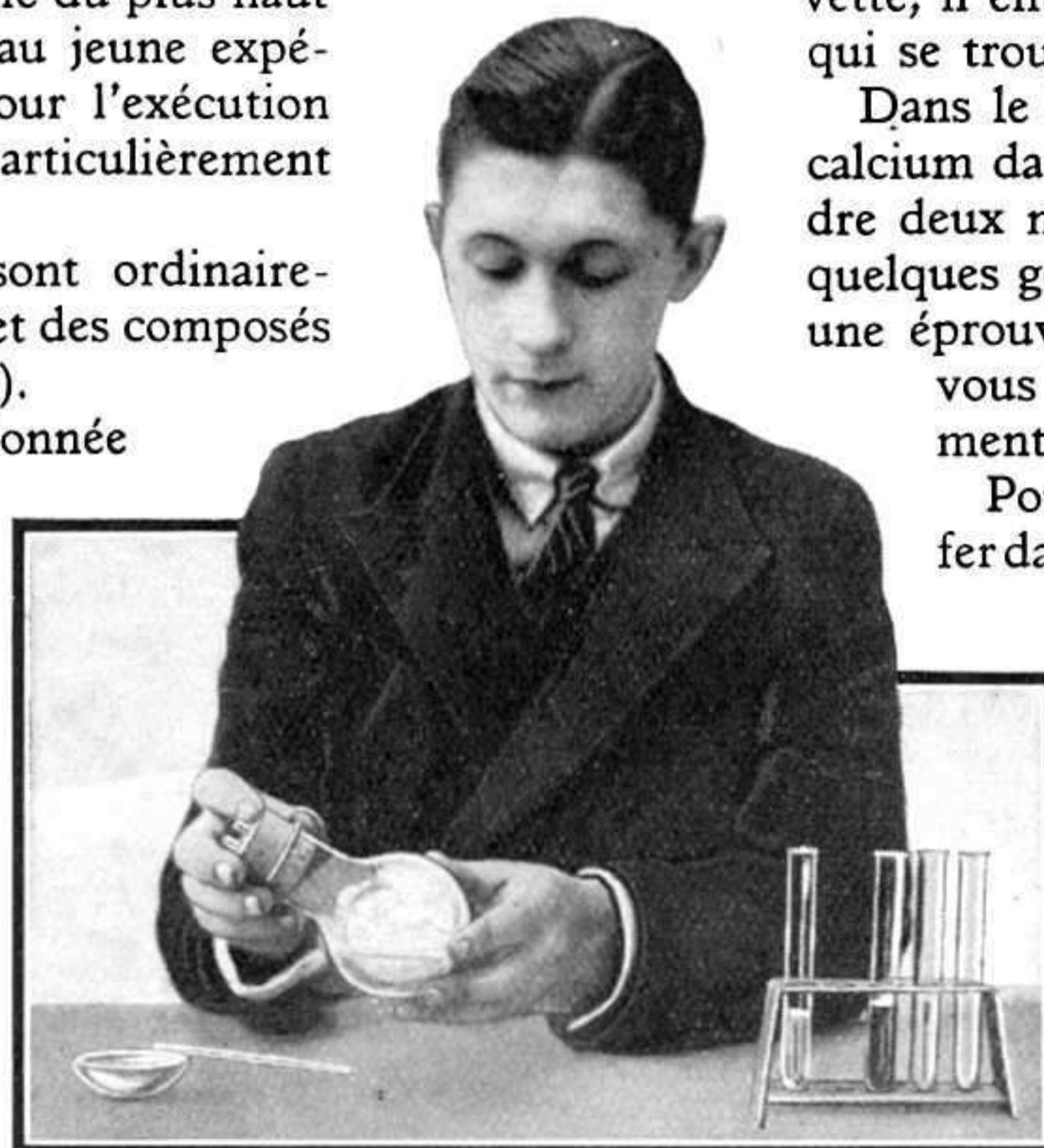
Agitez le mélange d'eau avec la solution de savon, afin de vous rendre compte du degré de la dureté de l'eau.
