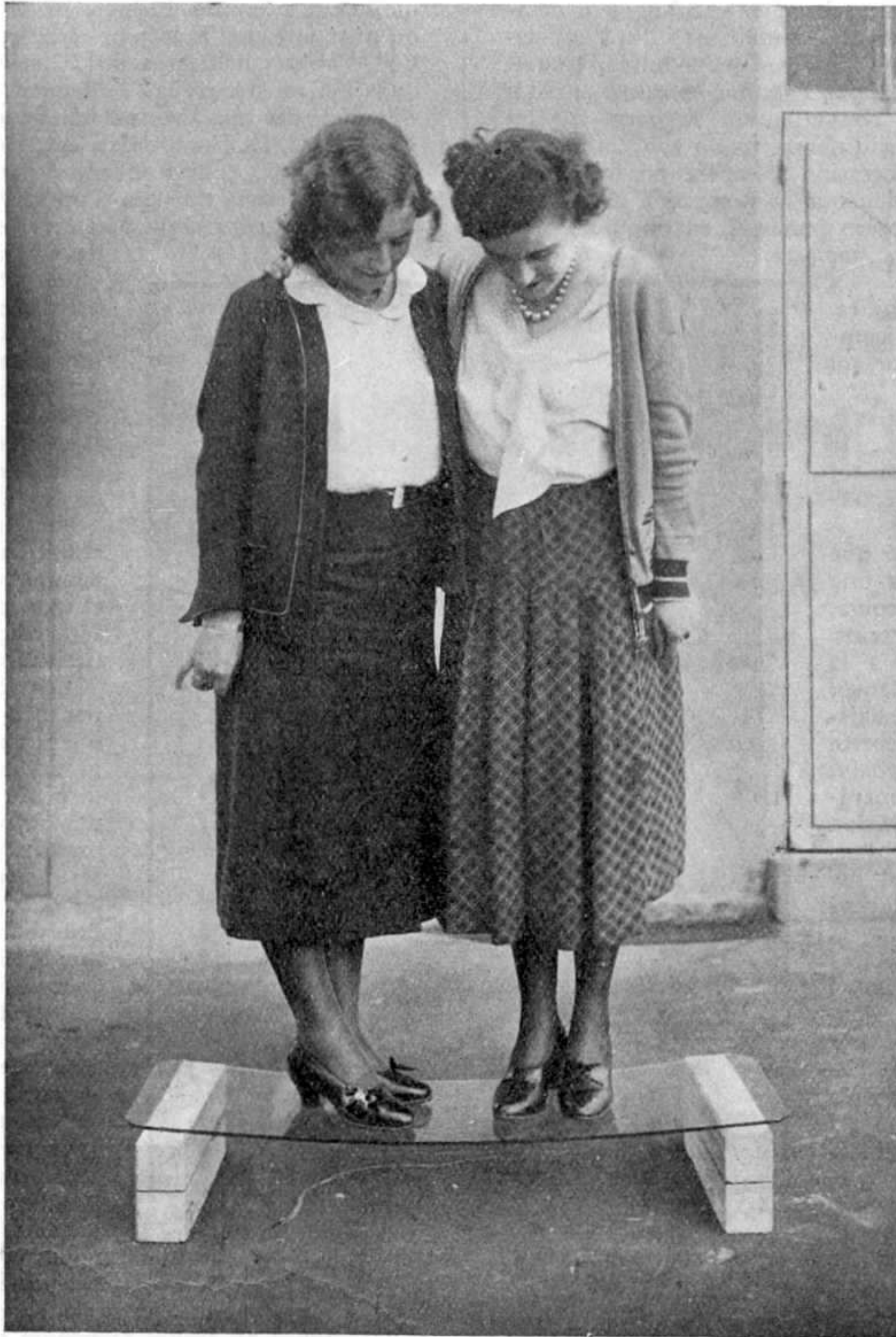
La souplesse de la glace Sécurité lui permet de résister à une forte charge sans se briser : elle s'incurve pour reprendre, après l'essai, sa rectitude première.
