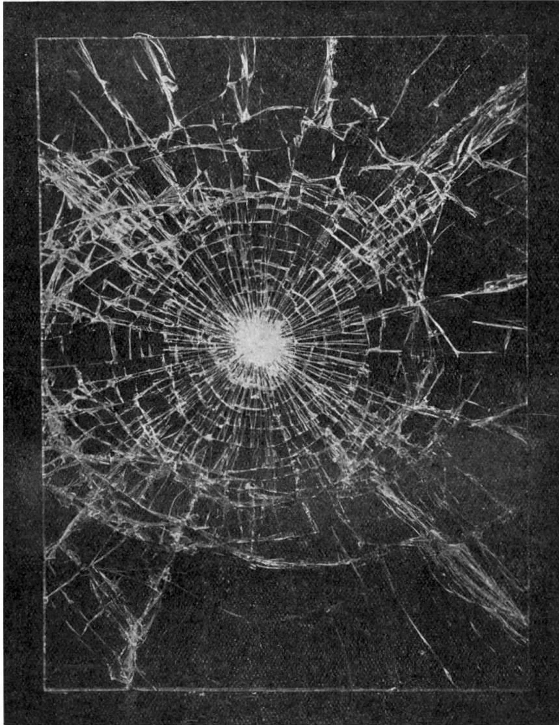
Vue d'une glace Triplex ayant reçu un choc violent. Le verre s'étoile en un réseau de fines fêlures sans qu'aucun éclat ne s'en détache. Le documentation que nous reproduisons nous a été confiée par la revue Glaces et Verres .
