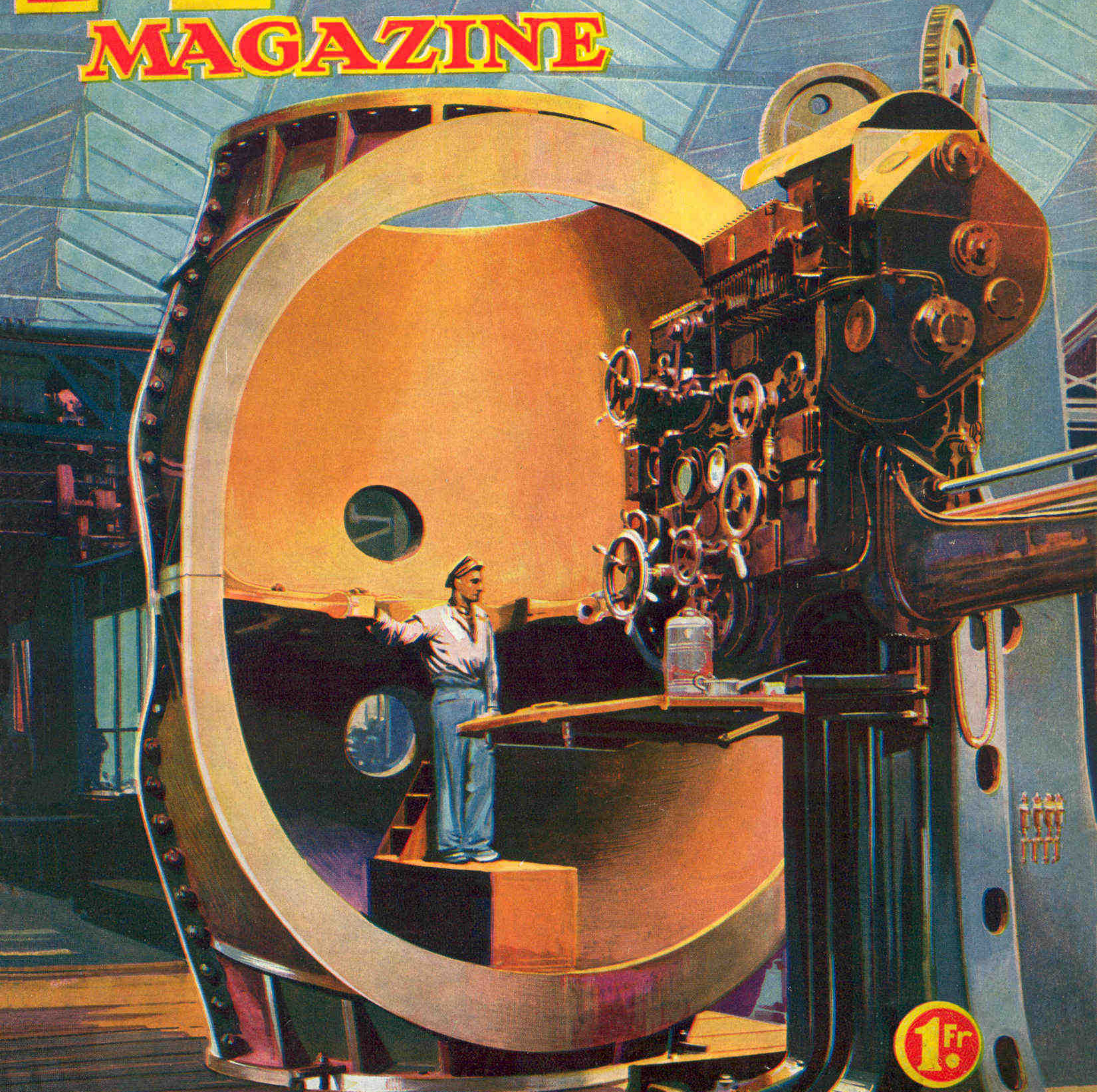
USINAGE D'UNE VANNE GÉANTE (voir page 58)
