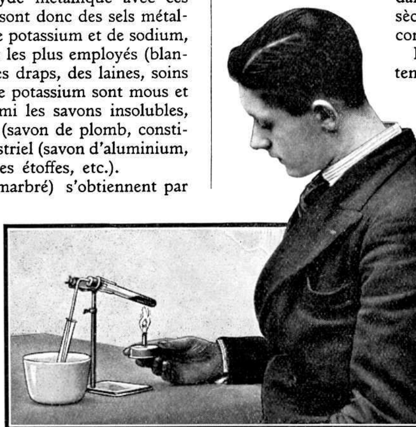
Fig. 3. — Préparation d'essence de girofle par distillation.
