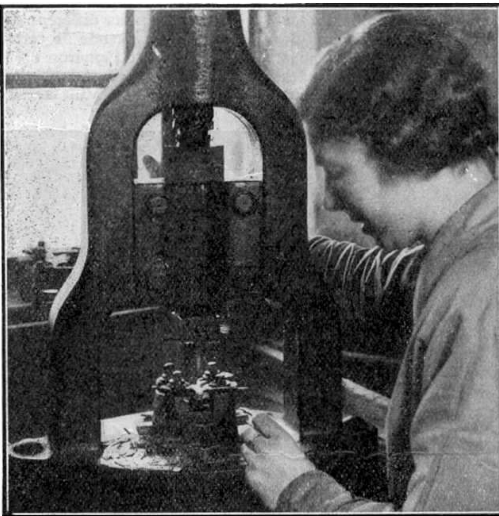
Fig. 4. — Chaque plume est introduite dans la matrice d'une presse qui lui donne la forme bombée définitive.
