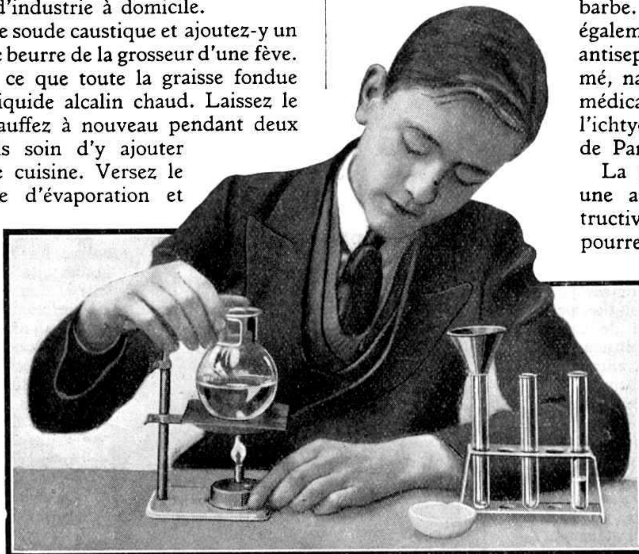
Fig. 2. — Préparation de sucre. On fait bouillir des rognures de betterave dans un ballon contenant de l'eau.
