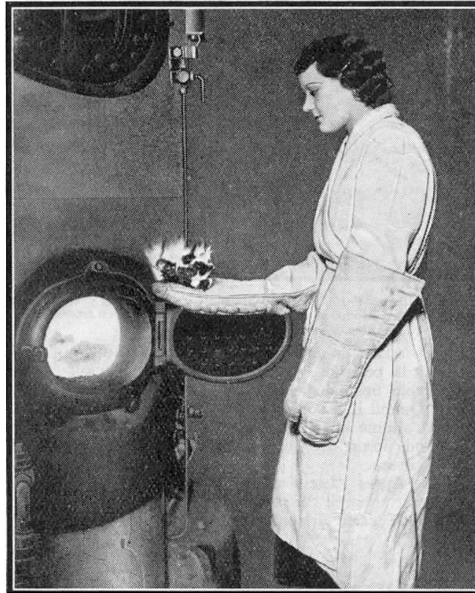
L'amiante, on le sait, résiste puissamment à l'action du feu. Le cliché ci-dessus, qui nous a été confié par la Société Bell's Asbestos and Engineering Supplies Ltd, fournit un exemple des emplois pratiques de ce minéral: une ouvrière tient dans sa main, protégée par un gant en tissu d'amiante, des charbons brûlants. Sa main isolée par l'amiante ne perçoit aucune sensation de chaleur. Rappelons que, dans notre numéro de mars dernier, nous avons parlé de l'emploi de l'amiante dans la fabrication des garnitures de freins et embrayages.
