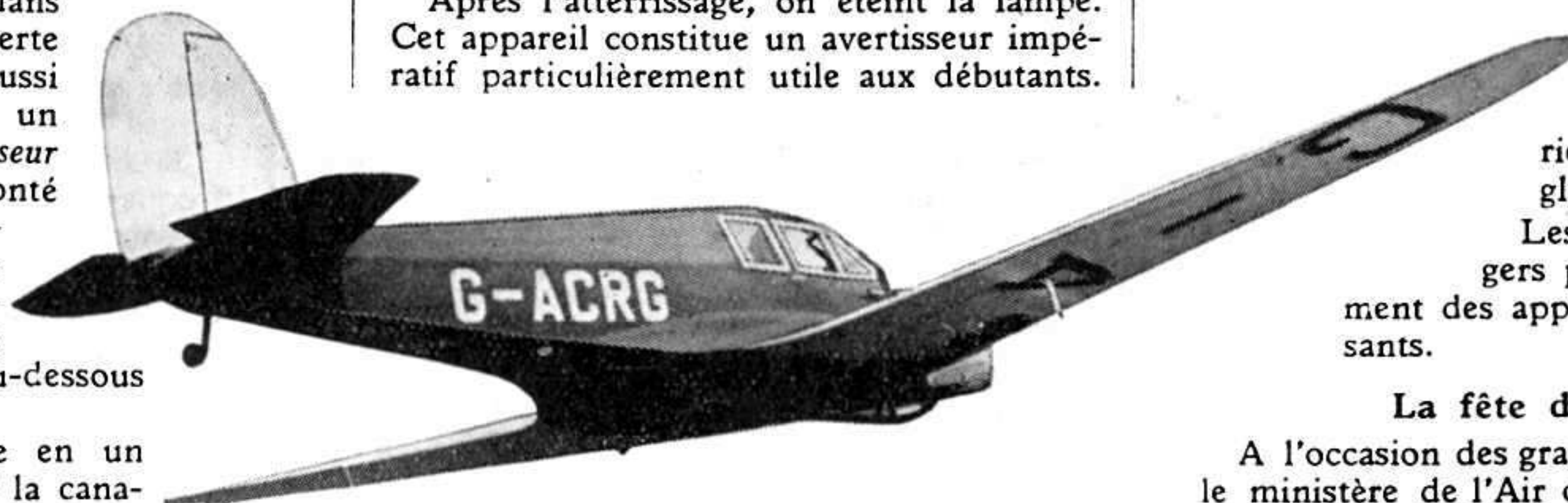
L'avion anglais Eagle, de la British Klimm Aeroplane Co Ltd., en plein vol. Cet avion est muni d'un train d'atterrissage escamotable qui, rentré dans le fuselage, diminue la résistance de l'appareil à l'avancement et permet d'augmenter d'environ 28 kilomètres sa vitesse horaire. Il atteint ainsi la vitesse de 273 km. heure.
