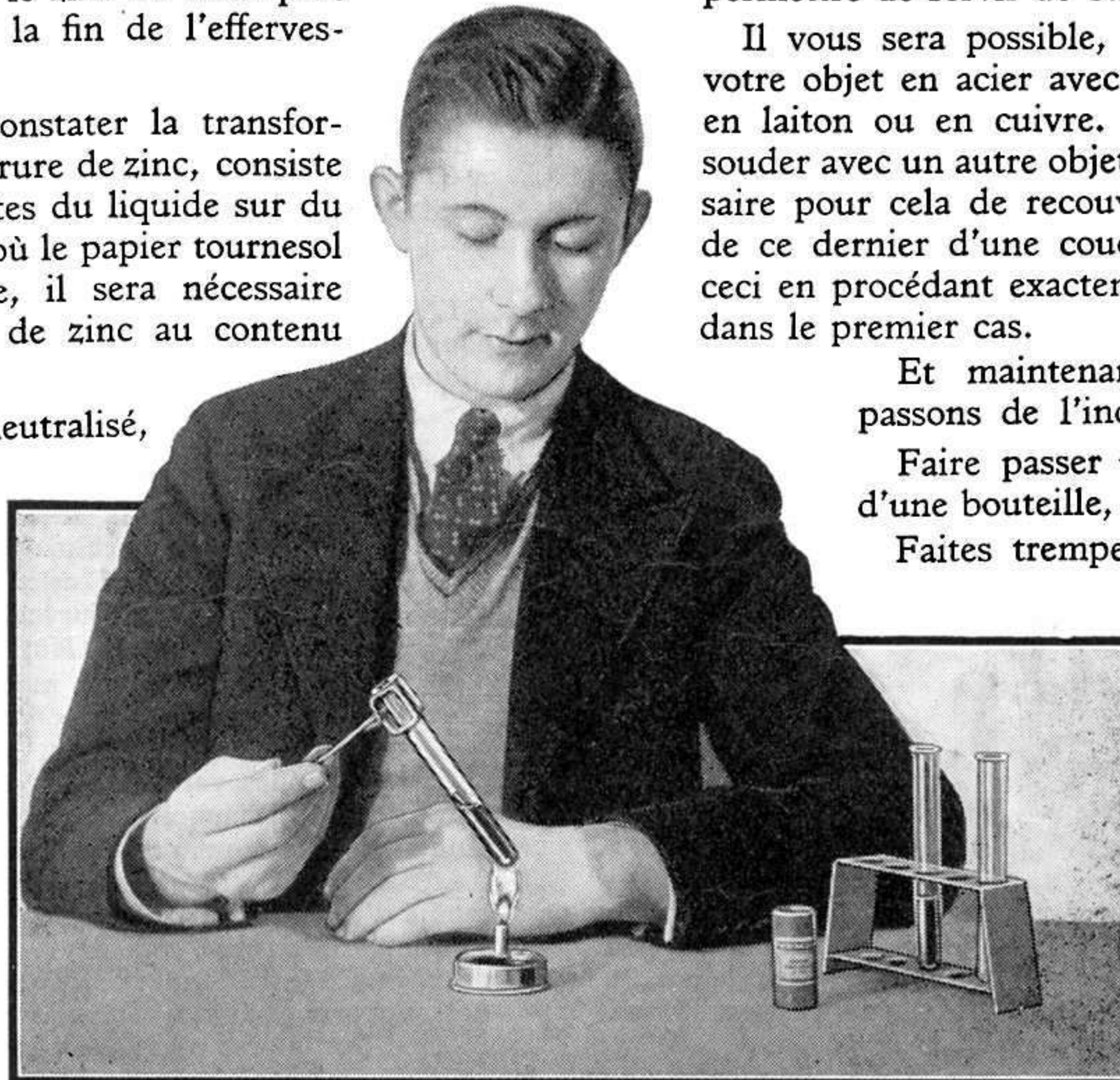
Fig. 3. — On obtient une solution de chlorure de zinc en faisant dissoudre du Zinc Granulé dans de l'acide chlorhydrique.
