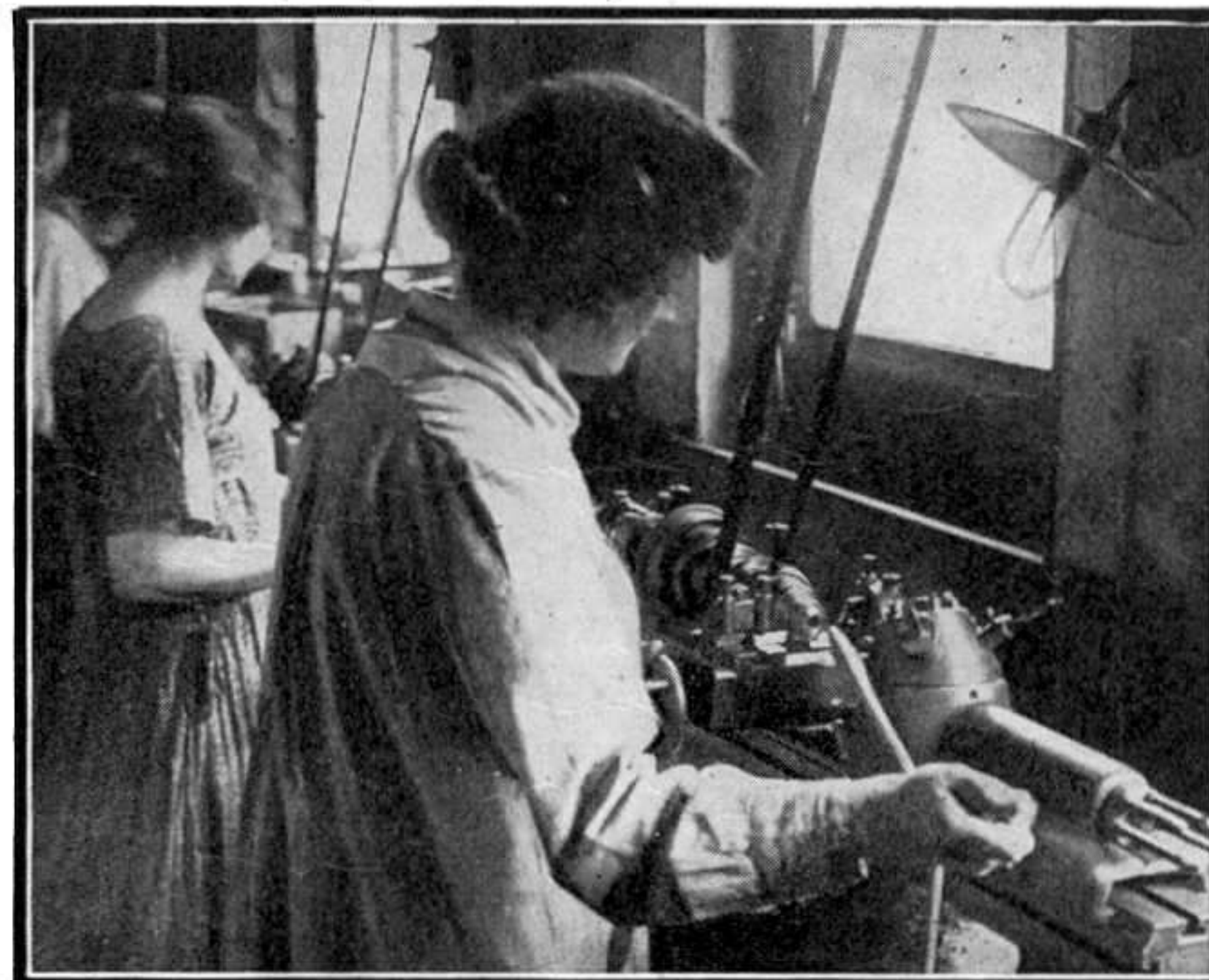
Fig. VI. — Décolletage des bâtons d'ébonite.
