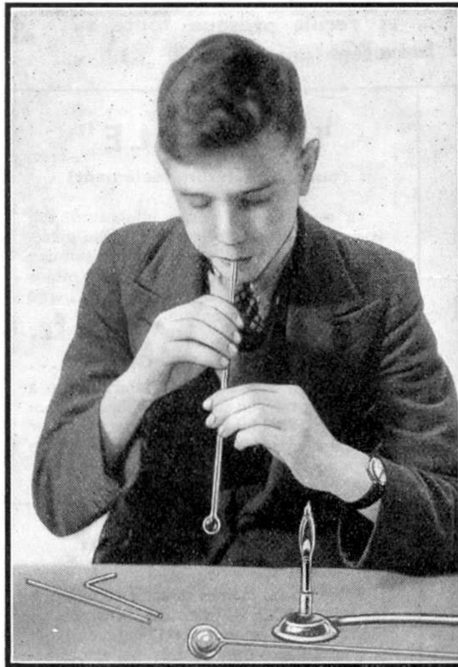
Le verre au bout du tube s'étant suffisamment amolli et ses parois s'étant refermées sur elles-mêmes à la fusion, soufflez dans l'orifice situé à son extrémité opposée.
