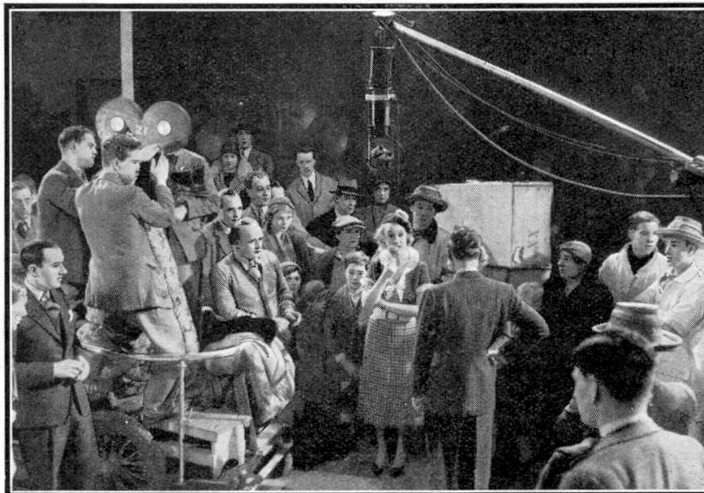
Prise de vue pour un film sonore. Suspendu au bout d'une longue tige articulée, au-dessus de l'endroit où les acteurs jouent une scène du film, le microphone est le premier des appareils dont l'ensemble sert à enregistrer les voix et les sons sur la bande sonore.
