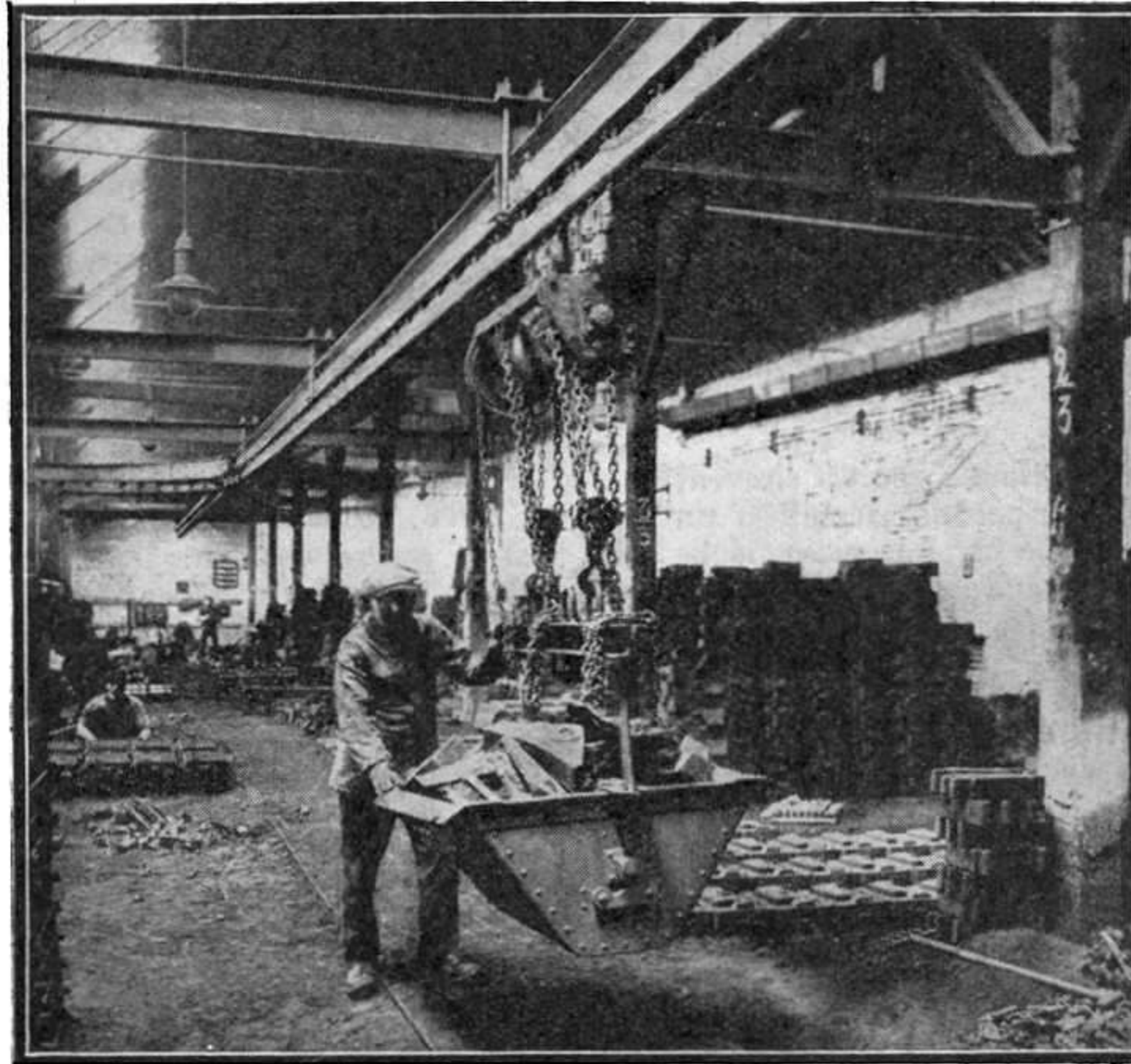
Vue d'un chariot-palan monorail à doubles crochets de levage, monté sur bogies accouplés (force 2.000 kgs). Les photographies illustrant cet article nous ont été confiées par les Établissements Tourtellier, de Mulhouse, qui ont mis au point ce système de manutention par voies suspendues.
