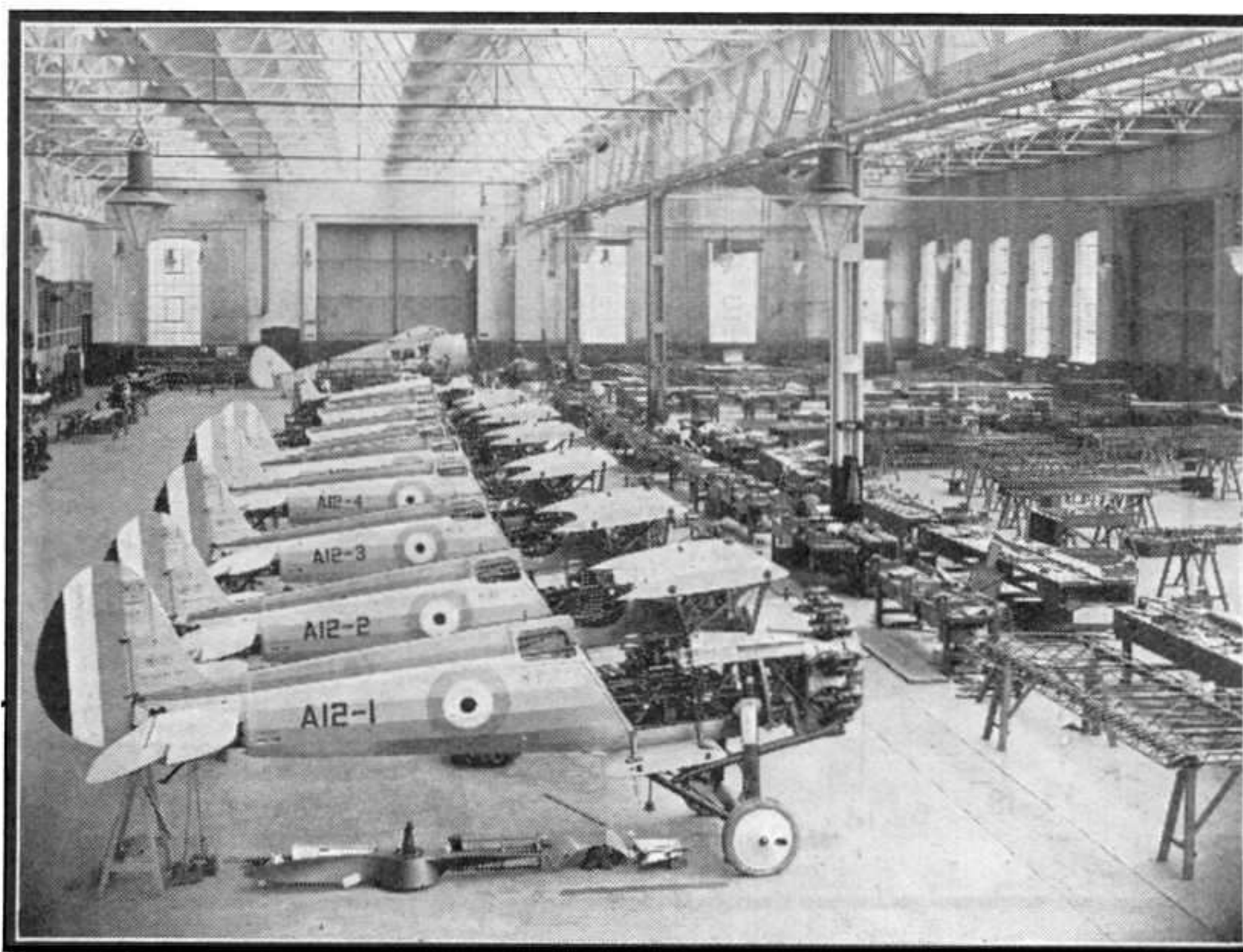
Construction en série d'avions "Bulldog" Bristol aux usines de la Compagnie des avions Bristol, à Filton, Angleterre.
