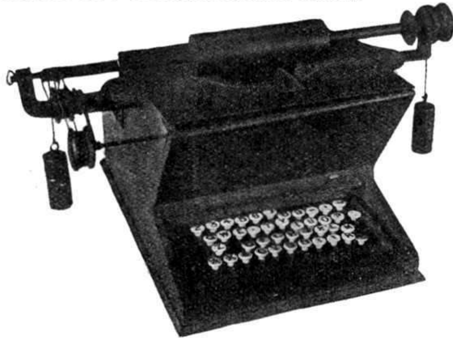
La machine à écrire de Sholes et Densmore (1872), dont le principe a servi de base aux machines Remington. La documentation pour cet article nous a été confiée par les Etablissements Remington Typewriter Company.
