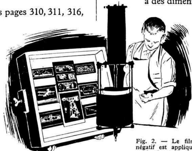
Fig. 2. — Le film négatif est appliqué sur la plaque de zinc dans un châssis, est préalablement sensibilisée et le tout, monté exposé à la lumière.
