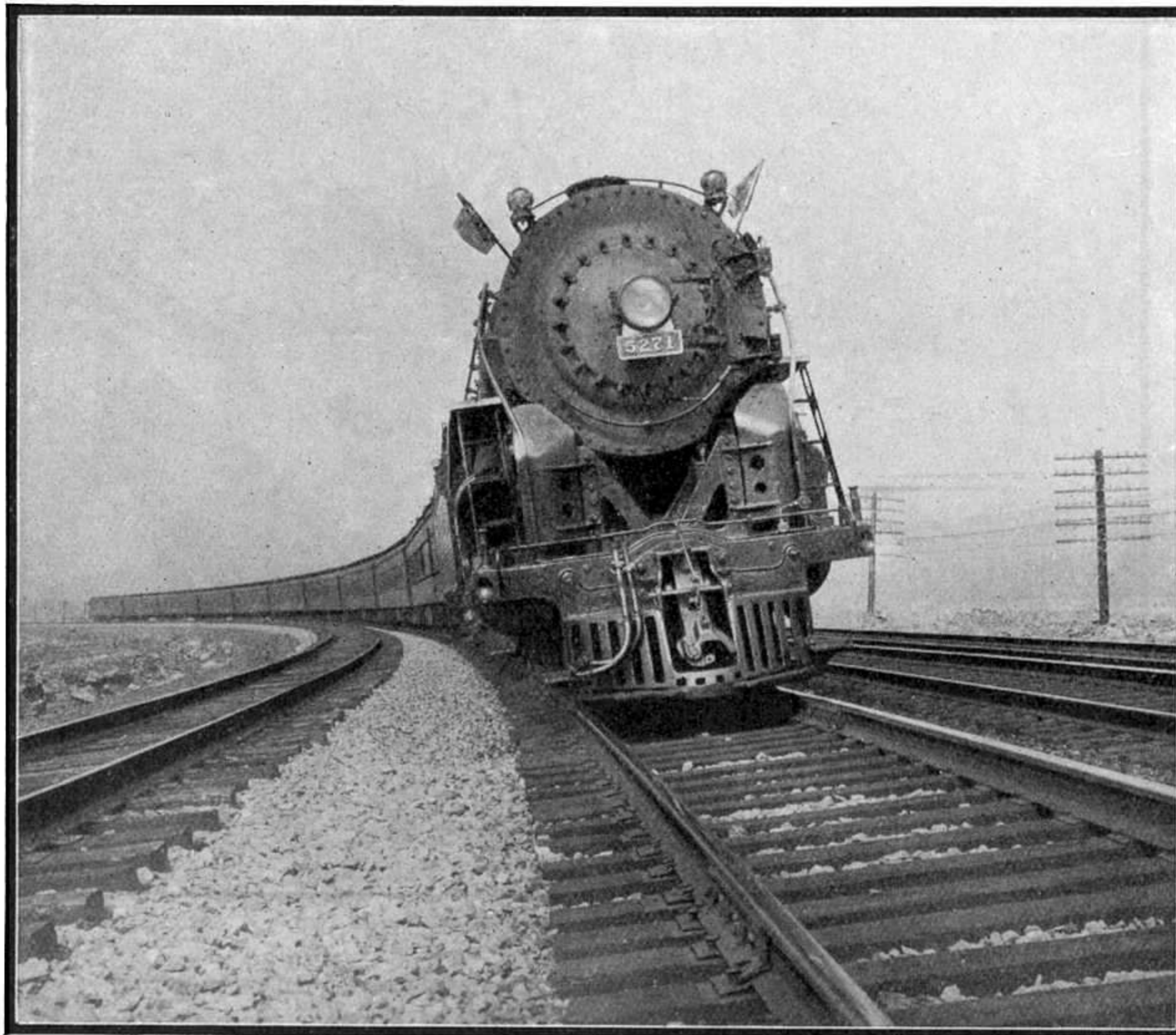
Vue impressionnante du fameux rapide de luxe américain Le XX e siècle , en service sur la ligne New-York-Chicago. Remorqué par une puissante locomotive Hudson , ce train suit les vallées pittoresques de l'Hudson et du Mohawk. Nos lecteurs remarqueront la nature de la voie américaine, son rail très haut au patin très fort, son travelage extrêmement serré. Ce document nous a été confié par la revue Chemins de fer , bulletin officiel de l'Association française des Amis des Chemins de fer.
