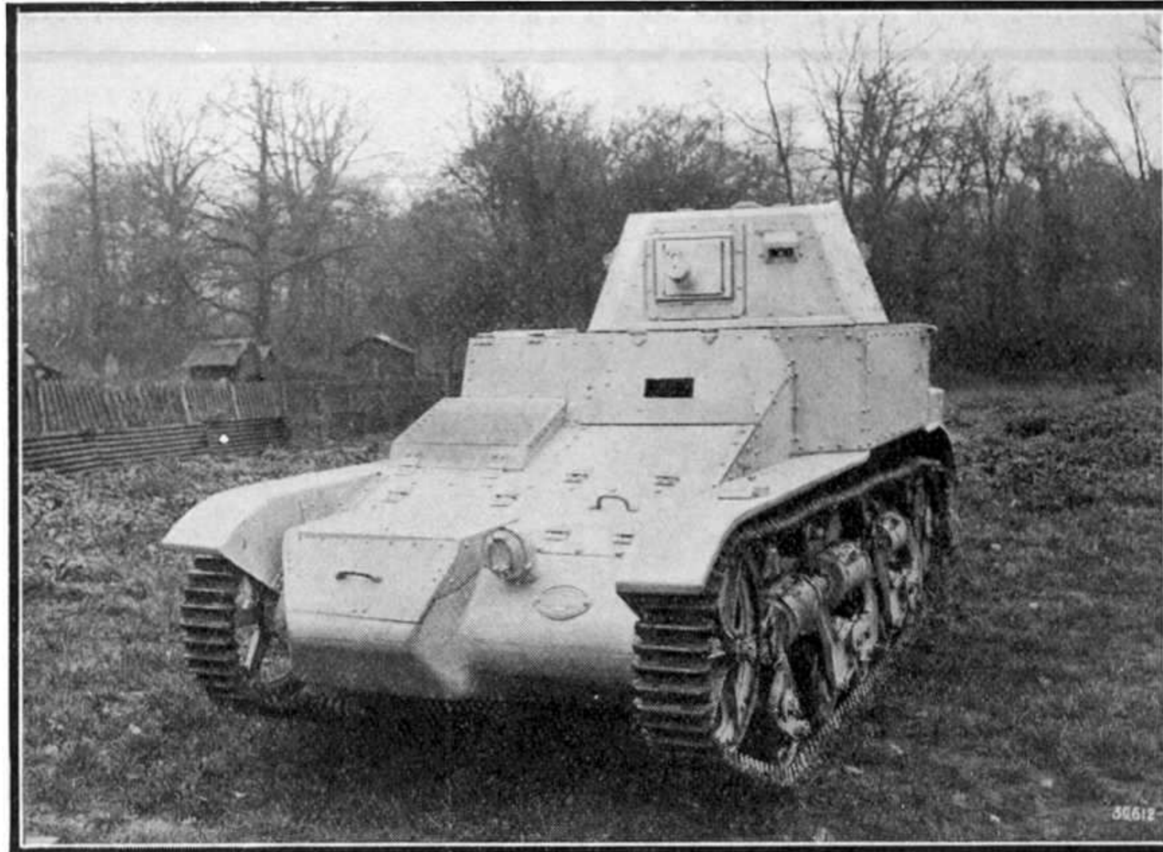
Vue d'un char léger rapide Renault, type ZB. Les documents que nous reproduisons nous ont été confiés par la Société Renault.
