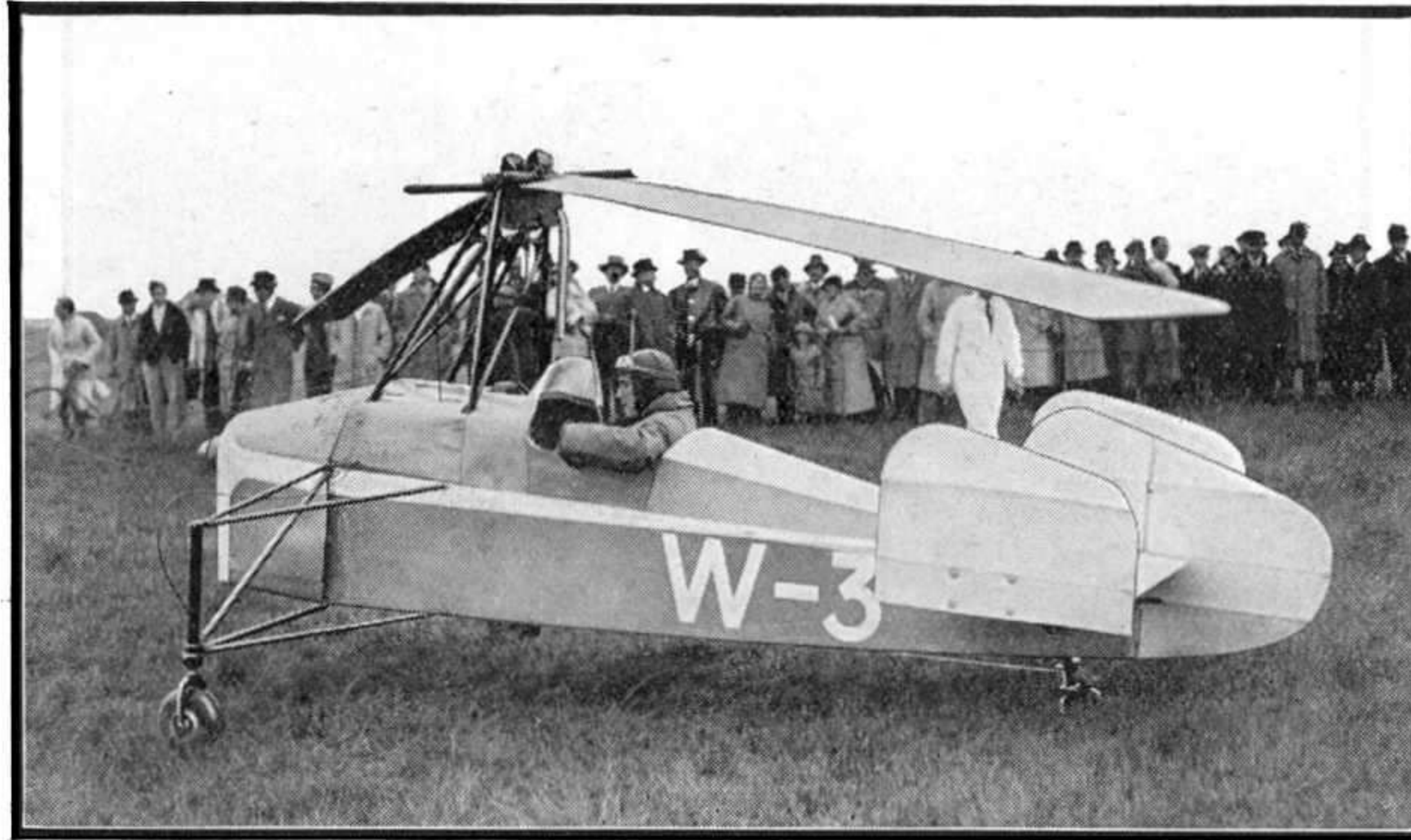
Autogire à décollage vertical construit par la Société G. et J. Weir de Glasgow. Les deux photographies que nous reproduisons nous ont été communiquées par la Cierva Autogiro Co., Ltd
