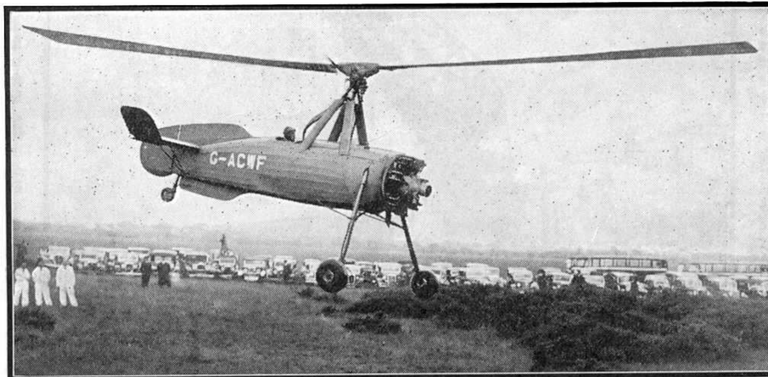
Le mois dernier, nous apportions la triste nouvelle de la mort tragique de Jean de la Cierva, inventeur de l'autogiro. Voici un de ces appareils, l'autogiro C-30, photographié au cours d'un décollage vertical qu'il exécute sans avoir roulé sur le sol. Cliché de la Cierva Autogiro Company Ltd d'Angleterre.
