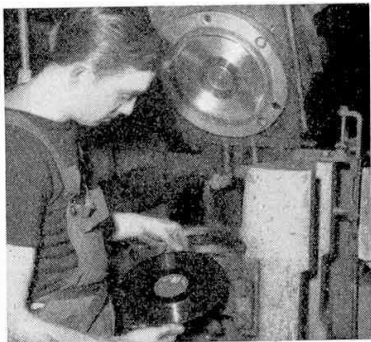
Premier examen par le conducteur de presse du nouveau disque. On aperçoit les deux faces de la matrice.
