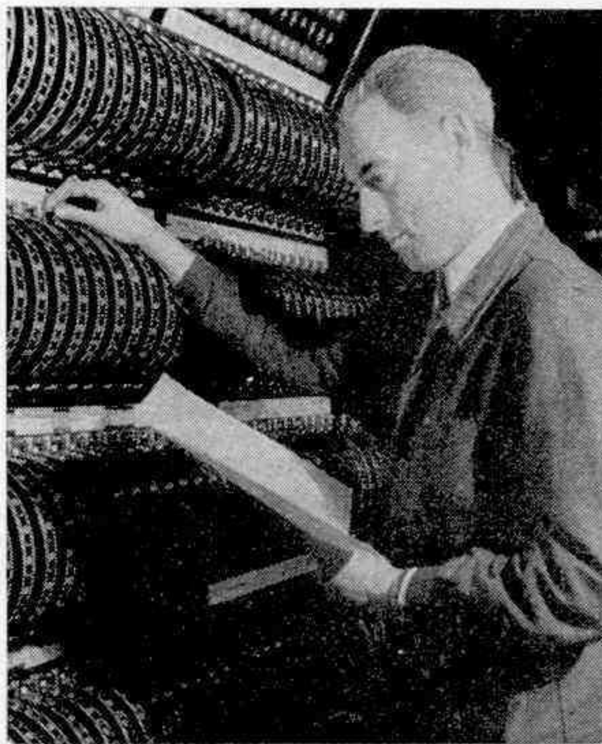
Un électricien du jeu d'orgues règle les intensités lumineuses : devant lui, des cylindres gradués de 0 à 100.
