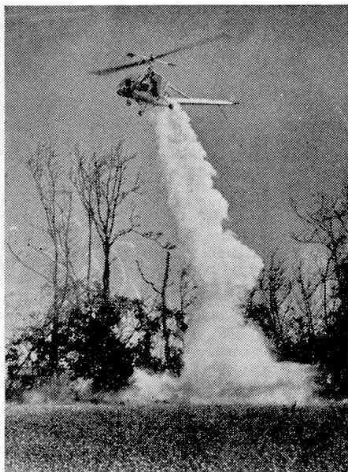
Une utilisation agricole de l'hélicoptère : un Hiller-360 pulvérise à faible altitude un produit insecticide contre les hannetons destructeurs de récoltes.
