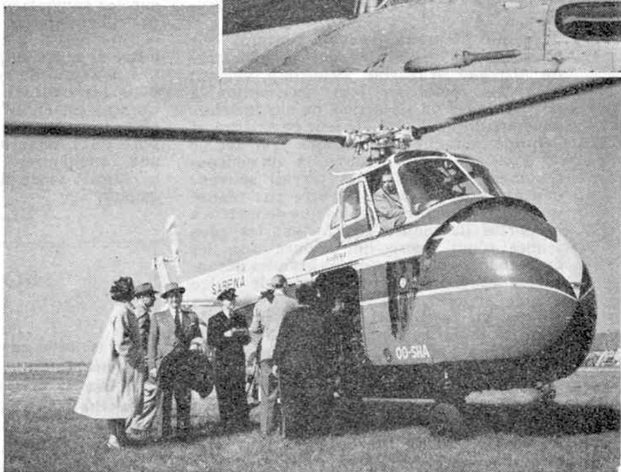
La Sabena a ouvert le premier service commercial international. Ci-dessus un de ses S-55 reçoit sept passagers sur le terrain de Melsbræk-Bruxelles et, plus haut, la partie centrale du rotor. Ci-contre, un appareil roule vers un hangar où il sera révisé : son avant s'ouvre aussi facilement que se soulève le capot d'une voiture.
