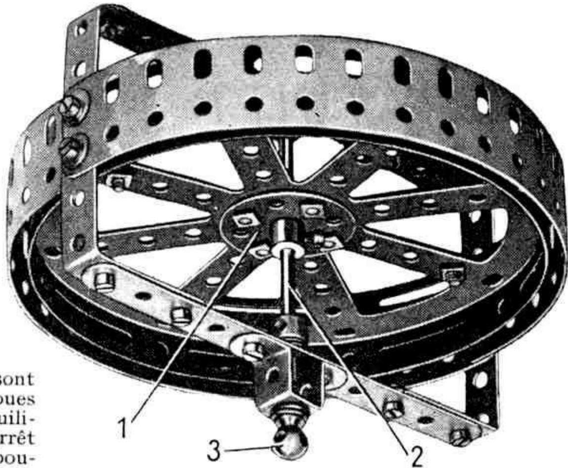
*Fonctionnement.* — Passez l'extrémité d'une ficelle souple derrière la vis d'arrêt d'une des roues barillets (1), et enroulez-la autour de la tringle (2). Vingt à trente tours suffisent. Tirez violemment sur la corde pour lancer le gyroscope, qui doit tourner vite : il faut que le volant « ronfle ». Vous pourrez alors le poser sur son pied à l'extrémité d'une bouteille, sur votre doigt ou sur n'importe quel support : il s'y tiendra en équilibre.
