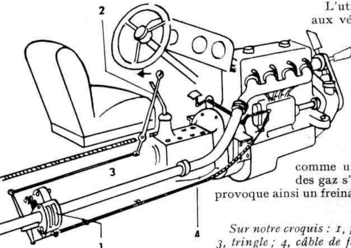
L'utilisation d'un ralentisseur permet aux véhicules de descendre toute côte en vitesse constante modérée sans utilisation des freins à friction. L'appareil est placé sur le tuyau d'échappement entre le pot et le collecteur. Il est relié d'une part à la cabine, par un levier de manœuvre, et d'autre part à la pompe d'injection. Les gaz sont bloqués entre le moteur et le frein. Le moteur travaille alors
