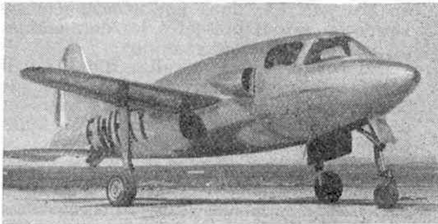
SO 6000 « TRITON ». Monoplan biplace (2 sièges éjectables). Turboréacteur : 1 Hispano « Nene » de 2.260 kg. de poussée. Env. : 9 m ,96. Long. : 10 m ,41. Poids : 5 t. Vit. max. : 955 km./h. Vlt. asc. : 50 m./s. Premier vol : 11 novembre 1946.
