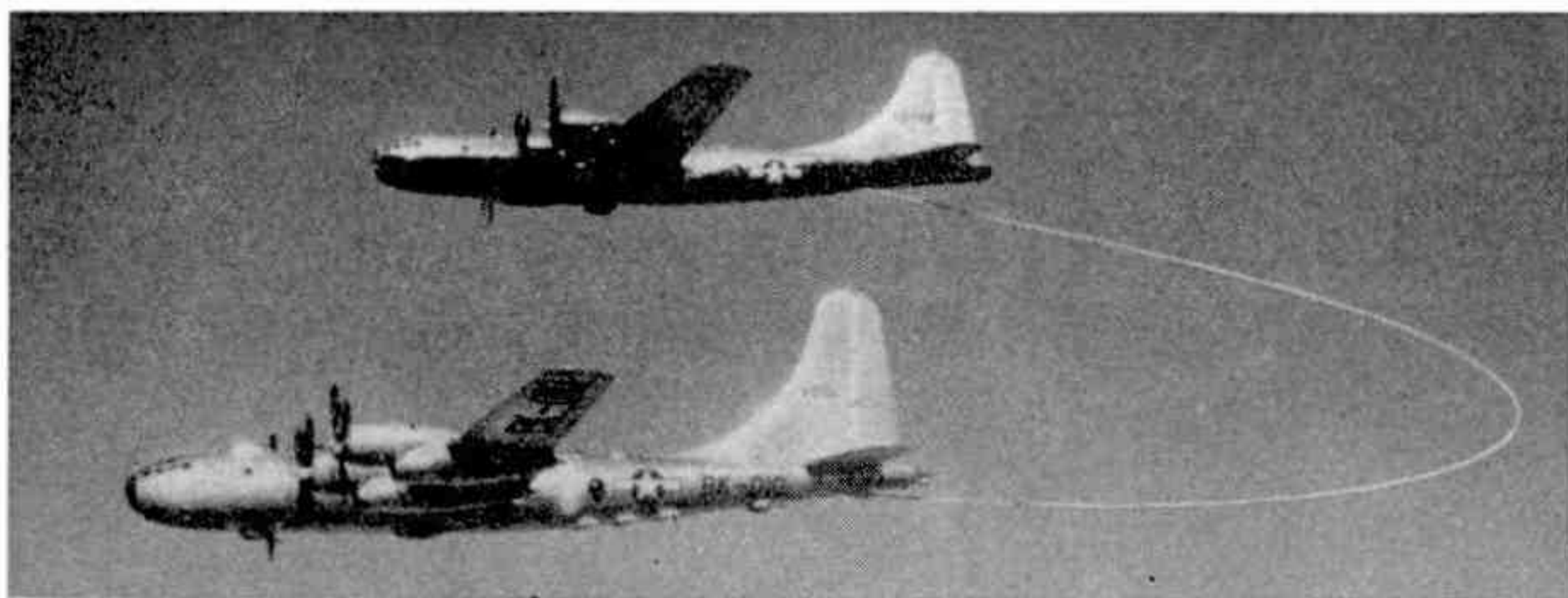
Pour préparer le tour du monde sans escales du B-50 de nombreux exercices furent nécessaires. On voit ici un B-50 (en bas) ravitaillé par un B-29 (en haut), suivant la méthode du tube souple.
