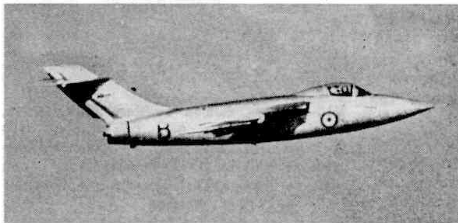
« BAROUDEUR » : Chasseur décollant sur chariot. Longueur : 13,49 m., envergure : 10 m. Propulsé par turboréacteur ATAR de 2.900 kg. de poussée. Poids avec armement : 6 t. Vitesse : 1.100 km.-h. Plafond : 12.000 m.
