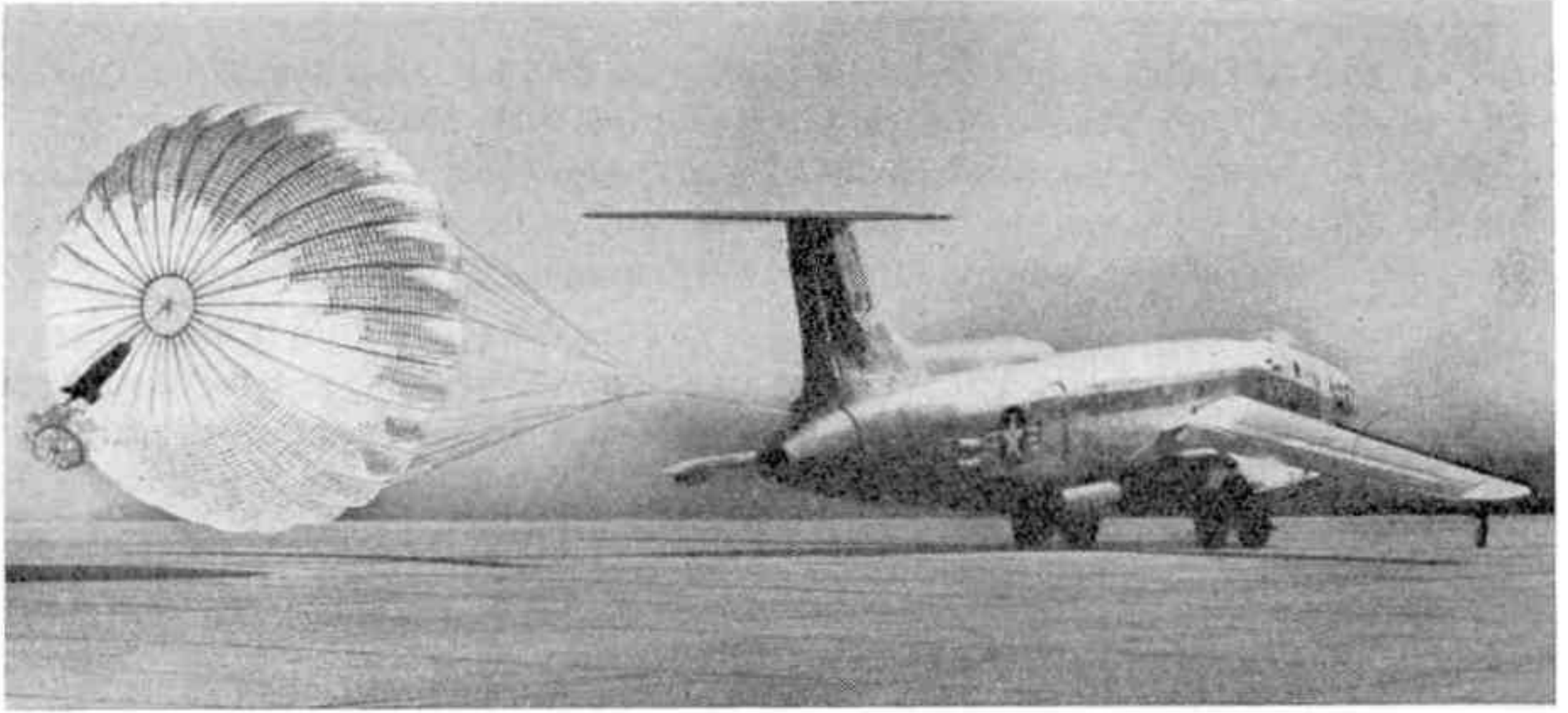
Pour se poser sur des terrains limités, cet avion à réaction américain, le XB-51, utilise un parachute-frein.
