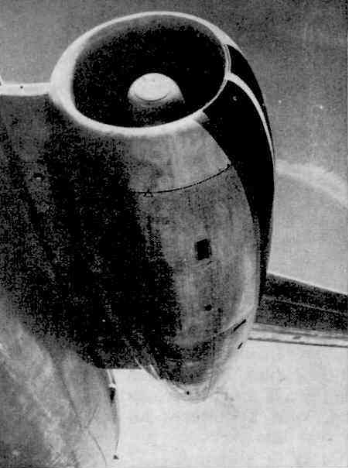
Les réacteurs arrière sont une des originalités du biréacteur : le bruit est en quelque sorte projeté derrière l'avion.
