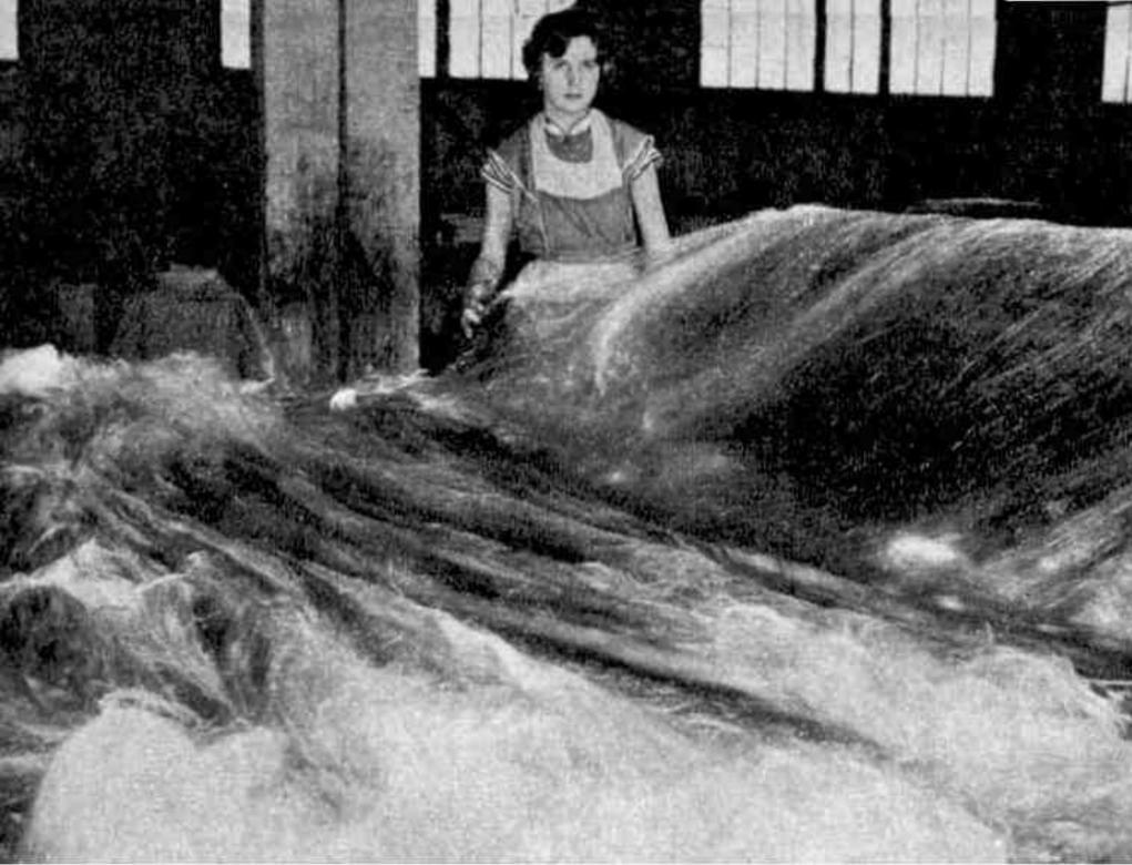
● *Atelier Fibres de verre de la firme Boussois. Les échevaux sont défilés avant d'être plongés dans une solution de formol et d'amidon.*
