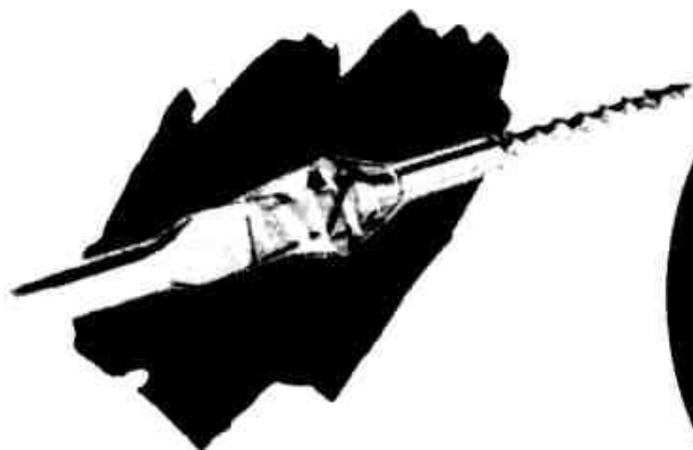
Pour introduire une vis dans un endroit inaccessible, vous la fixez au bout du tournevis avec SCOTCH.
