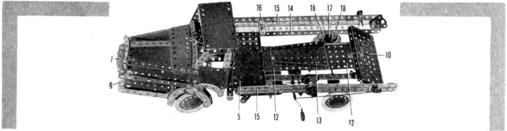
ports doubles (11). Le plancher est obtenu avec 2 plaques à rebords  $9 \times 6$  (12) reliées entre elles et raccordées d'une part à la plaque (5) et d'autre part à la plaque (10). Enfin, une plaque secteur à rebords (13) destinée à recevoir la benne est vissée sur la plaque (12).
