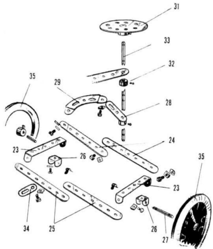
lieu de placer de part et d'autre une équerre double (26) destinée à recevoir la tringle (27) porte-roue (35).
