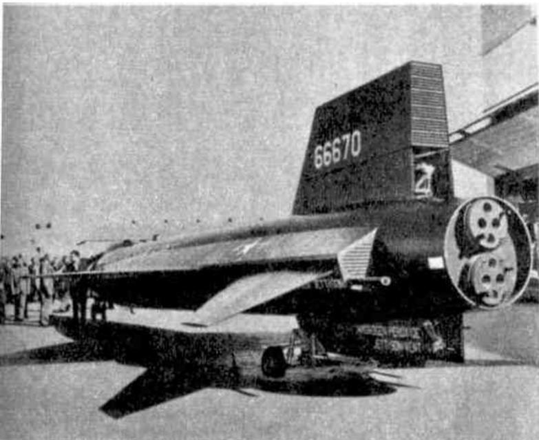
sphère. Le X-15 sera largué à 12 kilomètres d'altitude par un bombardier B-52. Deux fusées développant une poussée totale de 22.700 kilos lui imprimeront une impulsion suffisante pour l'engager dans une trajectoire préétablie qui le fera monter à plus de 160 kilomètres d'altitude, puis rentrer tangentiellement dans l'atmosphère. Le pilote d'essais Scott Crossfield, de la North American Aviation, doit le piloter.
