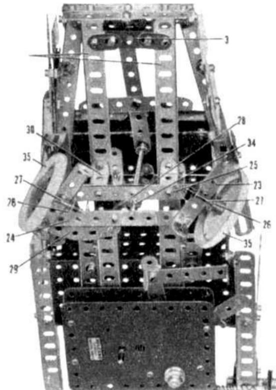
Deux bandes coudées  $60 \times 12$  (23) sont reliées entre elles par 2 bandes de 7 trous (24) raccordées sur 5 trous et par 2 autres bandes de 7 trous (25) raccordées également sur 5 trous mais fixées au centre des bandes coudées (23). Les pièces doivent pouvoir tourner et, dans ce cas, il faudra les visser à double écrous. Avant de visser les pièces 25 sur 23, il y aura
