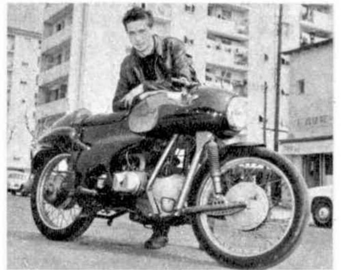
pois total de 170 kilos, cette machine d'une ligne puissante et racée, peut atteindre 170 kilomètres-heure. Elle ne consommerait que 4,5 litres de carburant pour 100 kilomètres.
