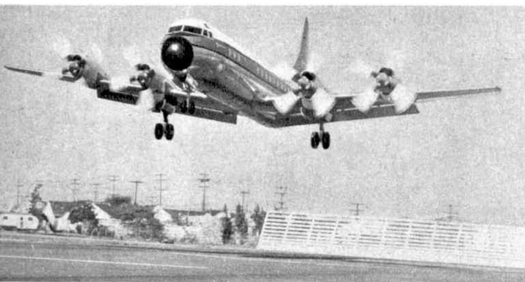
● L'« Electra » (U. S. A.), premier appareil civil à turbo-propulseurs, a accumulé au cours de ses essais plus de 100 heures de vol. Au cours de ces essais, l'« Electra » a atteint en palier, des vitesses supérieures à 740 kilomètres-heure pour une vitesse de croisière garantie de 650 kilomètres-heure (dans des conditions d'ailleurs bien définies d'altitude, de poids et de régime).
