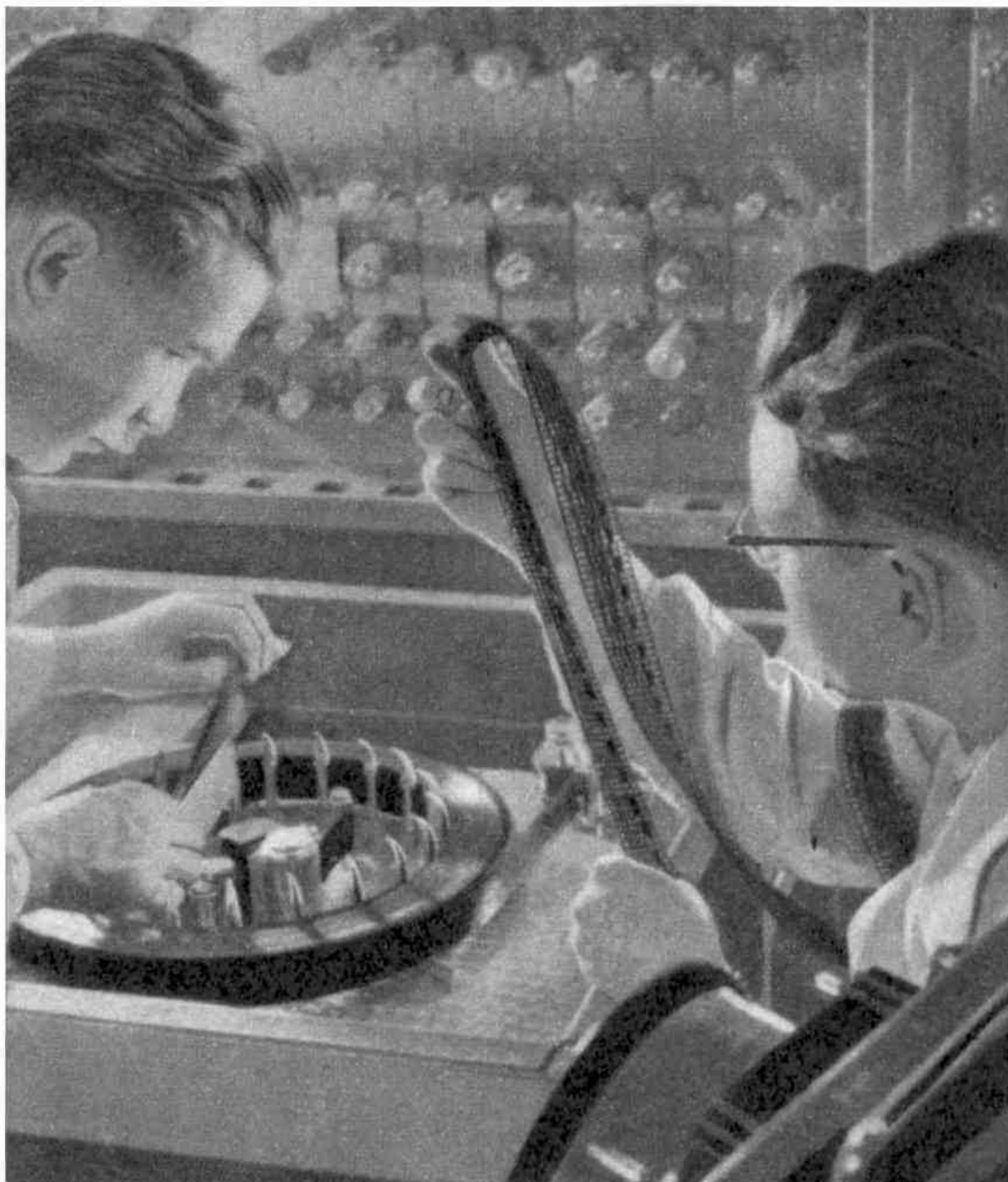
Ces opérateurs disposent la « mémoire » électronique de la calculatrice cybernétique « Oural » construite par les centres de calcul de l'Académie des Sciences de l'U.R.S.S.
