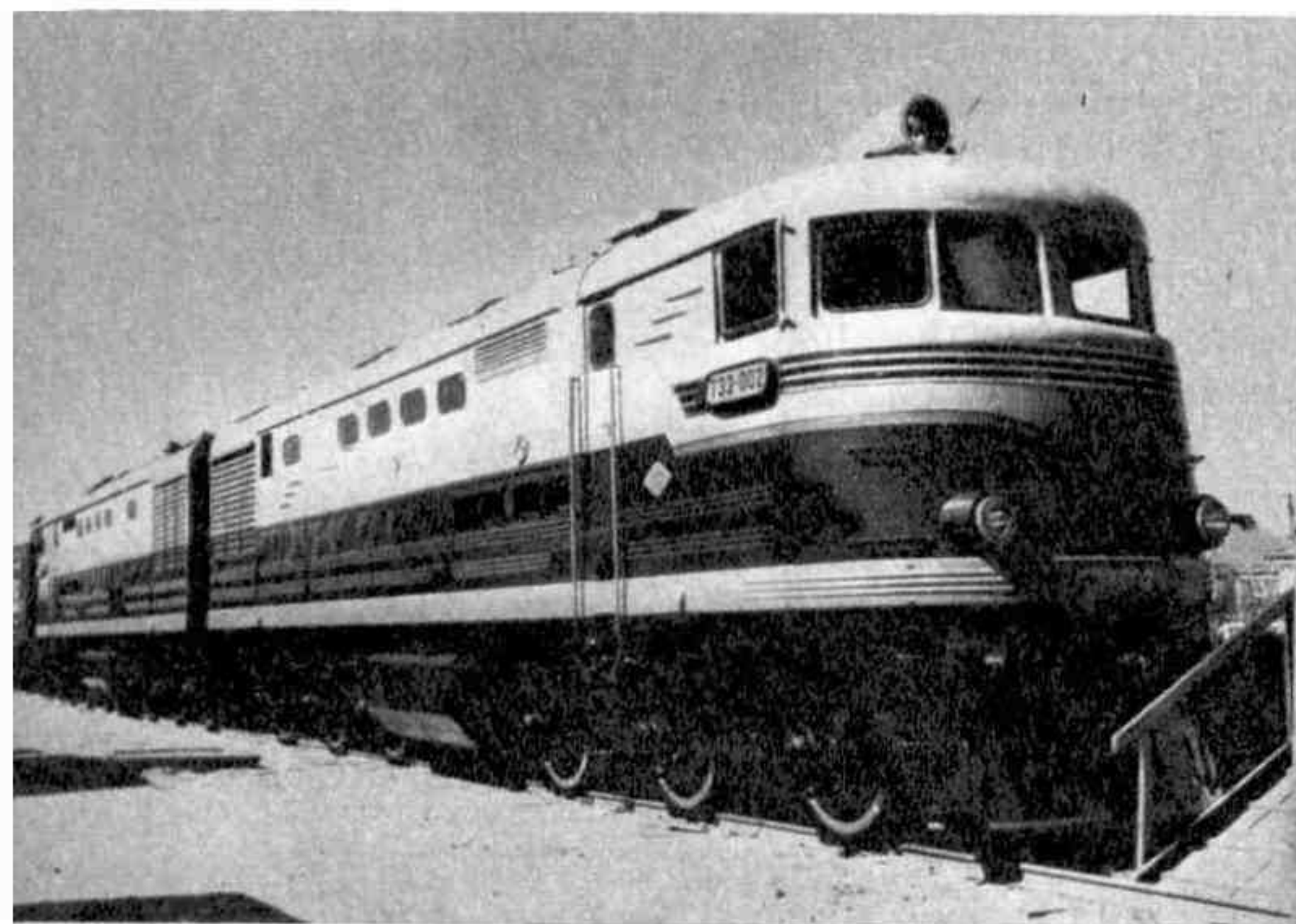
Locomotive diesel de série « TE 3 », construite par l'usine de Kharkov ; « TE-3 » pour convois de marchandise lourds, « TE-7 » pour trains de voyageurs. Puissance 4.600 CV. Remorque un convoi de 1.000 tonnes à 140 kilomètres-heure.
