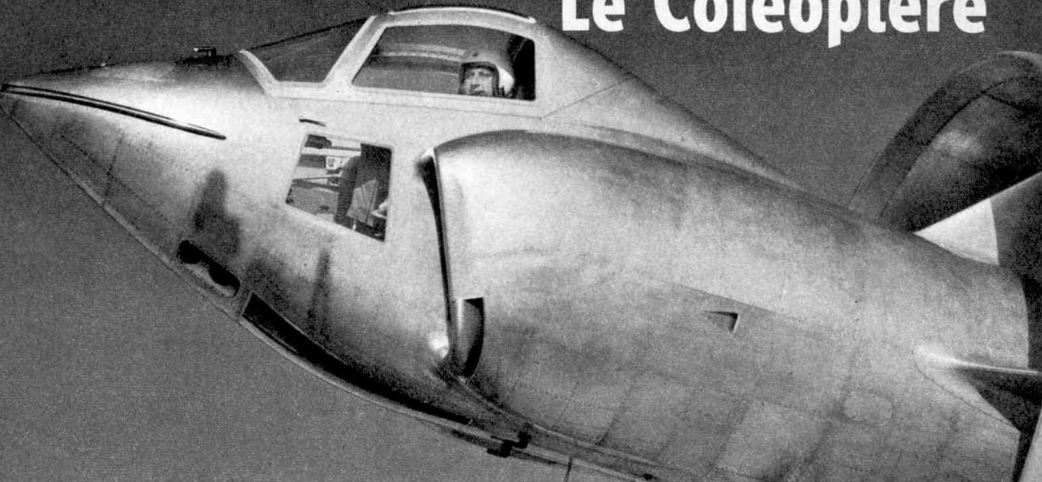
Auguste Morel, pilote d'essais, dans le poste de pilotage du Coléoptère C 450. Son siège éjectable bascule sur 55°
