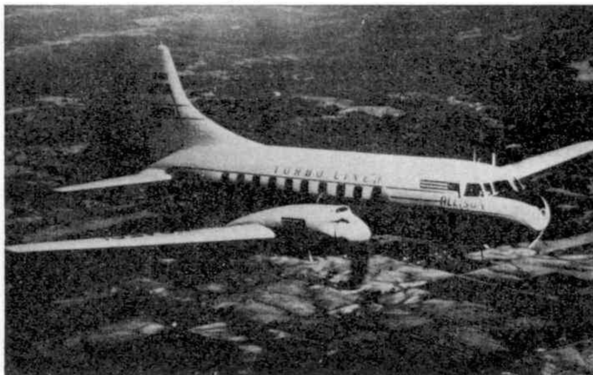
Une étape intermédiaire : la turbo-propulsion. Ci-dessous un Convair 240 muni de deux turbopropulseurs Allison T. 38.
