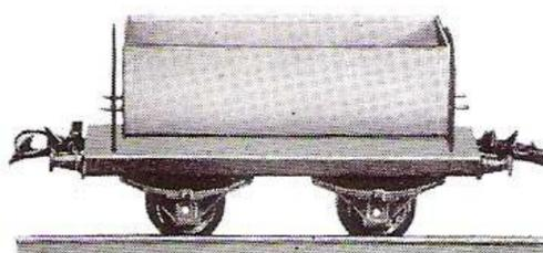
**Wagon-benne basculante (W. Ben.)**. Long. 15,5 cm. La benne bascule d'un côté ou de l'autre.
